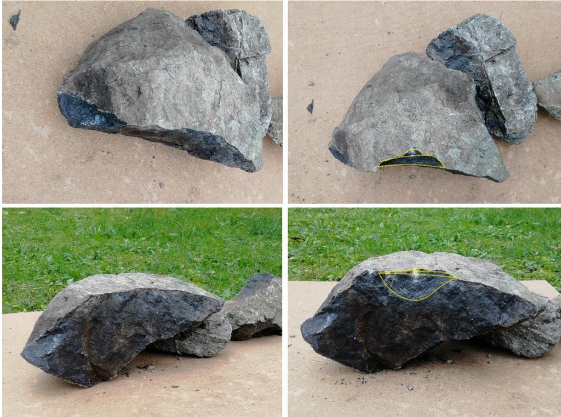
Abb. 27b Bruchkörper bei Belastung in einiger Entfernung von der Felskante
