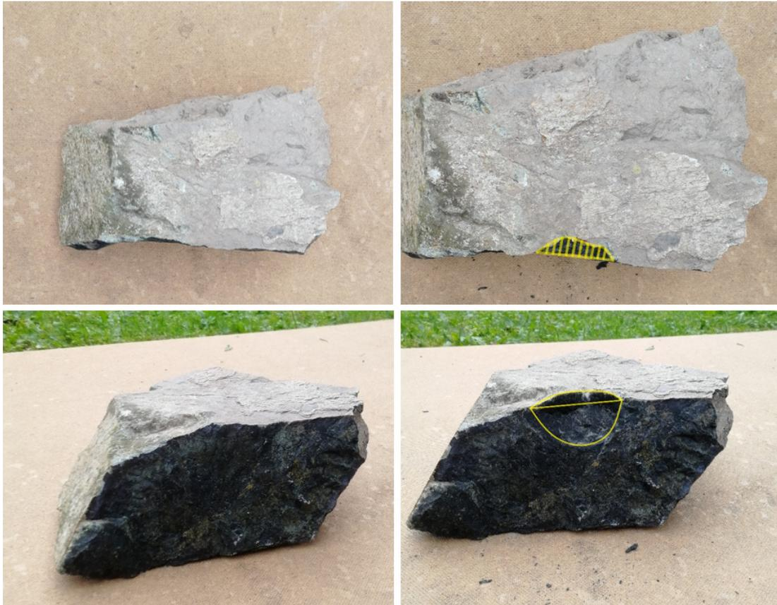
Abb. 27a Bruchkörper bei Belastung nahe der Kante
