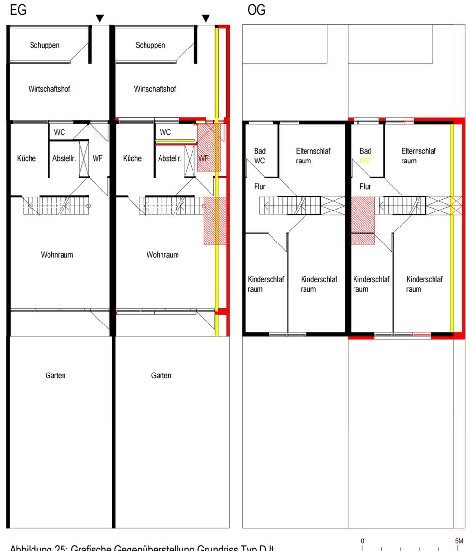
Abbildung 25: Grafische Gegenüberstellung Grundriss Typ D lt. Bauordnungsnovelle 1985 bzw. OIB Richtlinie 2015
