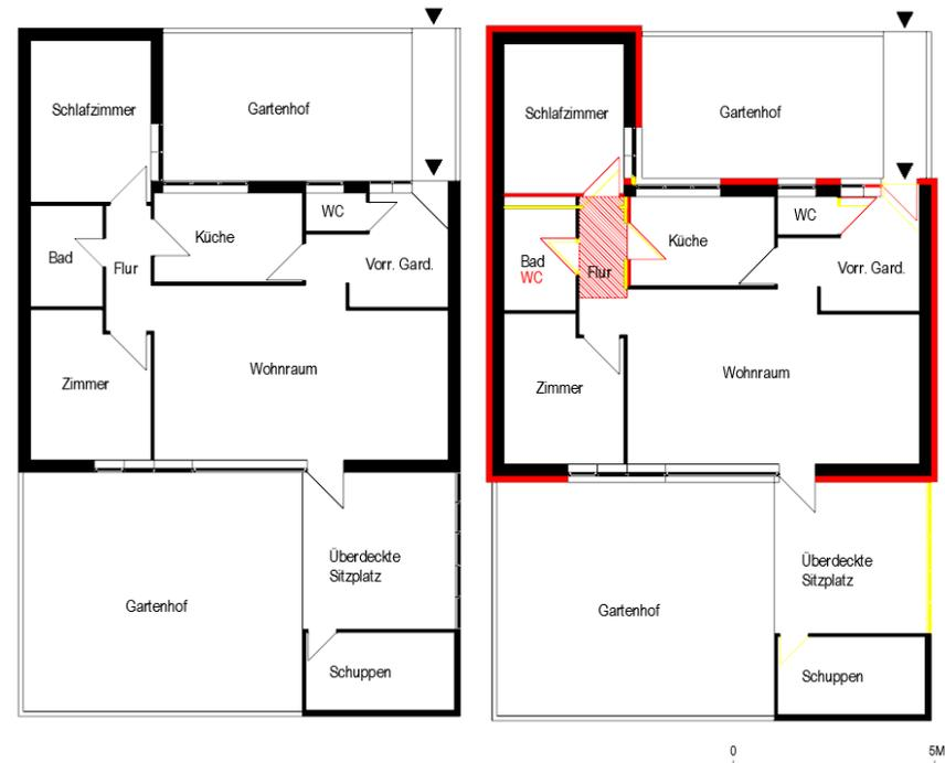
Abbildung 50: Gegenüberstellung Grundriss Typ J1 lt. Bauordnung 1976 und Bauverordnung 1976 bzw. OIB Richtlinie 2015
