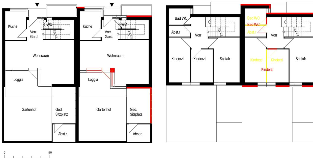
Abbildung 55: Grafische Gegenüberstellung Grundriss Typ h lt. Bauordnung 1976 und Bauverordnung 1976 bzw. OIB Richtlinie 2015
