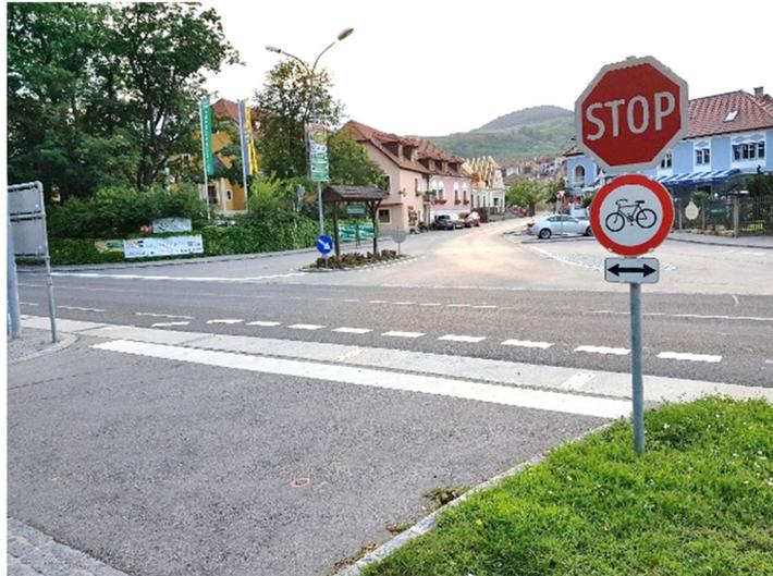
Abb. 73: Falsche Anbringung einer Ordnungslinie
