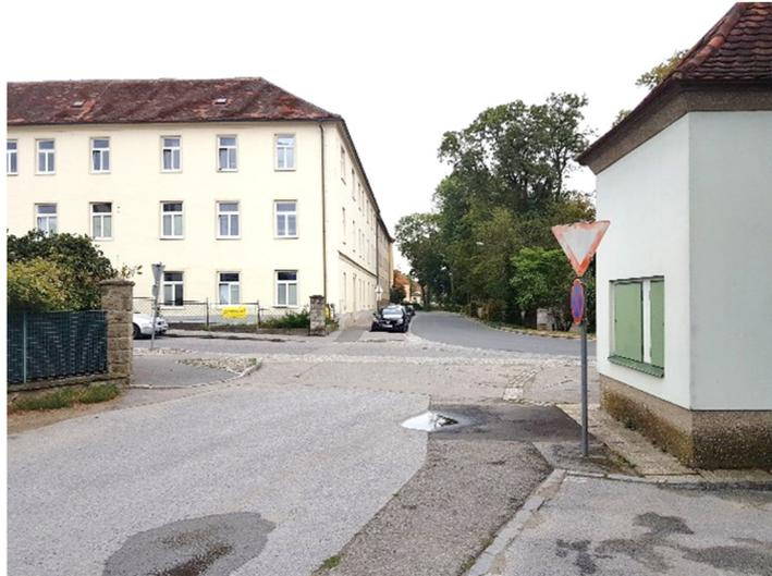
*Abb. 72: Schaffung einer gefährlichen Vorrangsituation auf Grund fehlender Zusatztafel*
