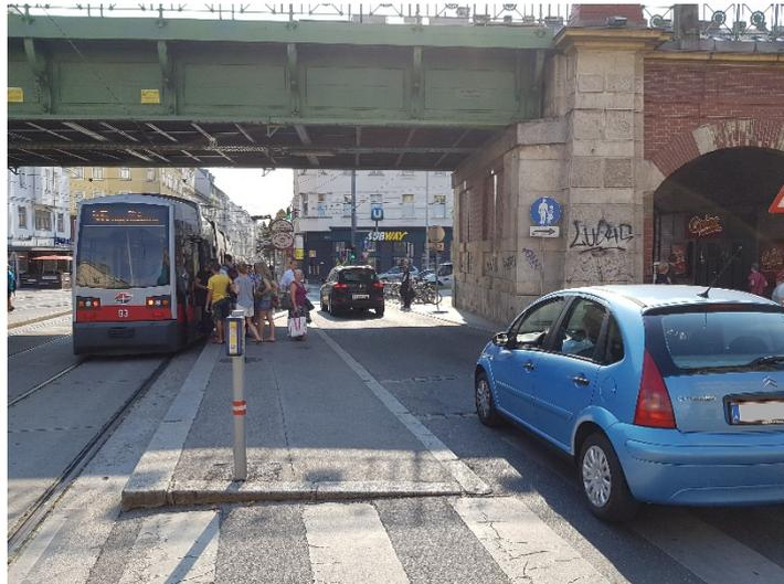
Abb. 101: Schaffung einer Konfliktsituation durch Anhebung der Fahrbahn und fehlende Absperrung in einem Haltestellenbereich
