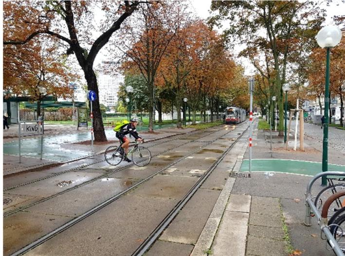
*Abb. 87: Gefährliche Anlage einer unzureichend gekennzeichneten Radfahrerüberfahrt über einen selbstständigen Gleiskörper*
