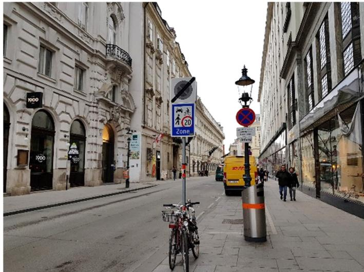
Abb. 91: Falsche Kundmachung einer gebührenpflichtigen Kurzparkzone und einer Halte- und Parkverbotszone
