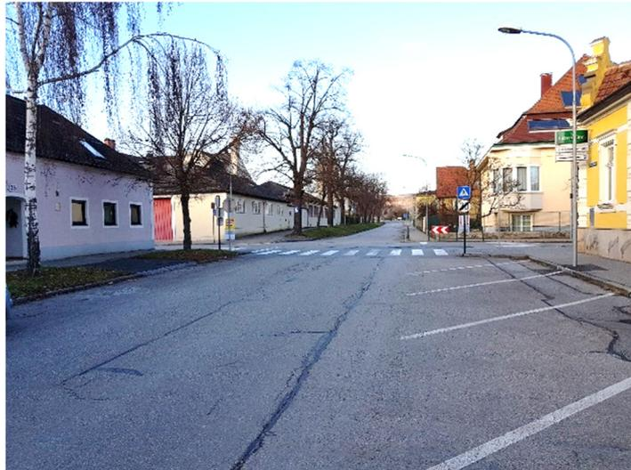
*Abb. 78: Unzureichende Anbringung des Hinweiszeichens „Kennzeichnung eines Schutzweges“ in einer Einbahnstraße*
