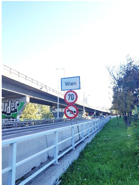
*Abb. 65: Unbeabsichtigte Gültigkeit einer Geschwindigkeitsbeschränkung für das gesamte Ortsgebiet*
