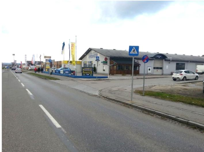
Abb. 77: Anbringung des Hinweiszeichens „Kennzeichnung einer Radfahrerüberfahrt“ abseits einer Radfahrerüberfahrt
