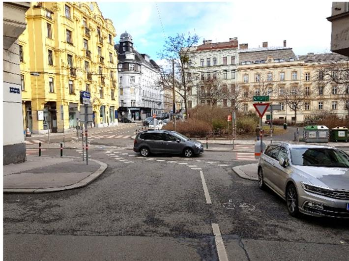
*Abb. 79: Schaffung einer Gefahrensituation durch Kombination „Vorrang geben“ mit einer Radfahrerüberfahrt*
