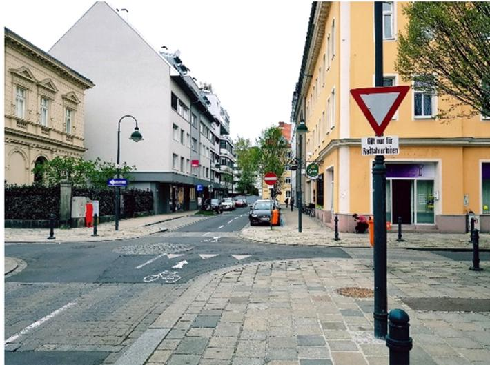
*Abb. 80: Anbringung von ungeeigneten Richtungspfeilen im Kreuzungsbereich*
