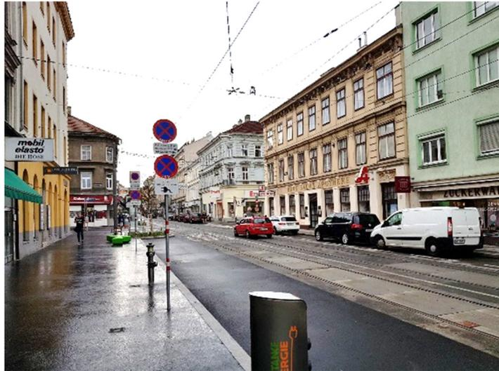
Abb. 97: Unbenützbarkeit eines Parkstreifens auf Grund einer Sperrlinie und Sperrfläche
