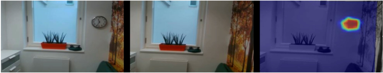
Bild 5. HMD-Screenshots: Alter Zustand (links), Neuer Zustand (mitte) und Change-Detection in Echtzeit (rechts) Abb.: DAQRI Fig. 5. HMD-Screenshots: Former state (left), new state (middle) and change detection in real time (right) Source: DAQRI
