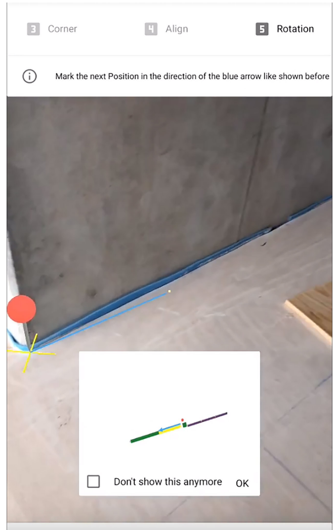
Bild 7. Verortung über Eingabe eines Vektors [9] Abb.: Gamma AR Fig. 7. Localization by entering a vector [9] Source: Gamma AR
