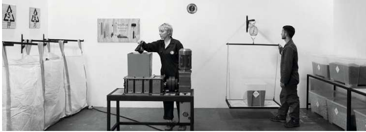
Abb.18 Schreddern in kleinteilige Granulate als Grundmaterial für die weitere Verarbeitung
