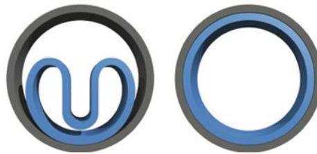
Abb. 5.11: Querschnitt verformte Rohre (links beim Einziehen, rechts nach dem Aufstellen) 114
