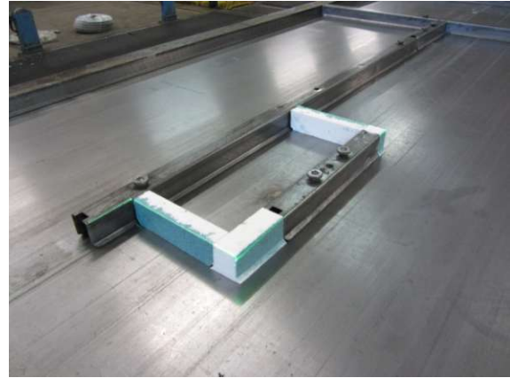
Abb. 2.13: Styroporkörper als Schalung
