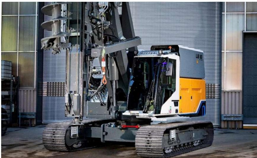
Abbildung 19: Akkubetriebenes Großdrehbohrgerät [29]
