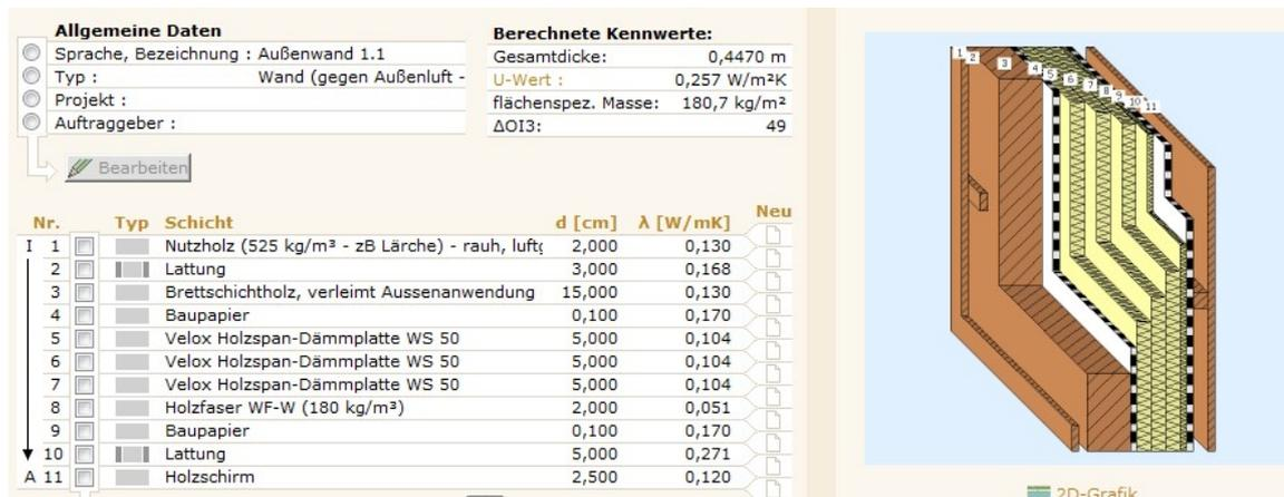
Abb. 19 Brettschichtholz wand mit Holzleichtbetonplatten – voller Aufbau [33]
