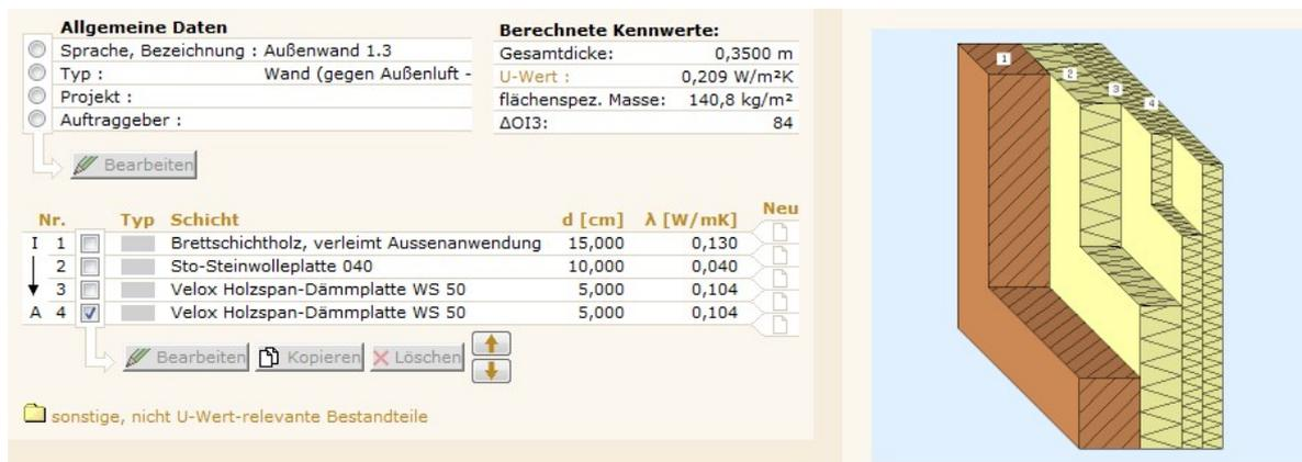
Abb. 20 Brettschichtholz wand mit Holzspanbeton und Steinwolle [33]
