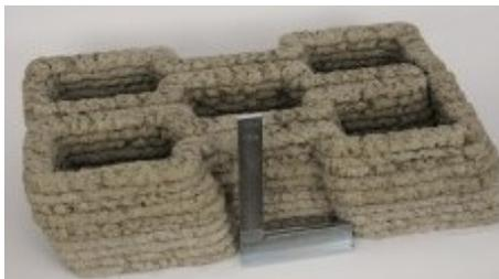
Abb. 69 extrudierte HLB-Bauteile [41]
