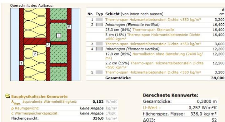
Abb. 23 Holzmantelbetonstein Fa.Thermo-span [33]
