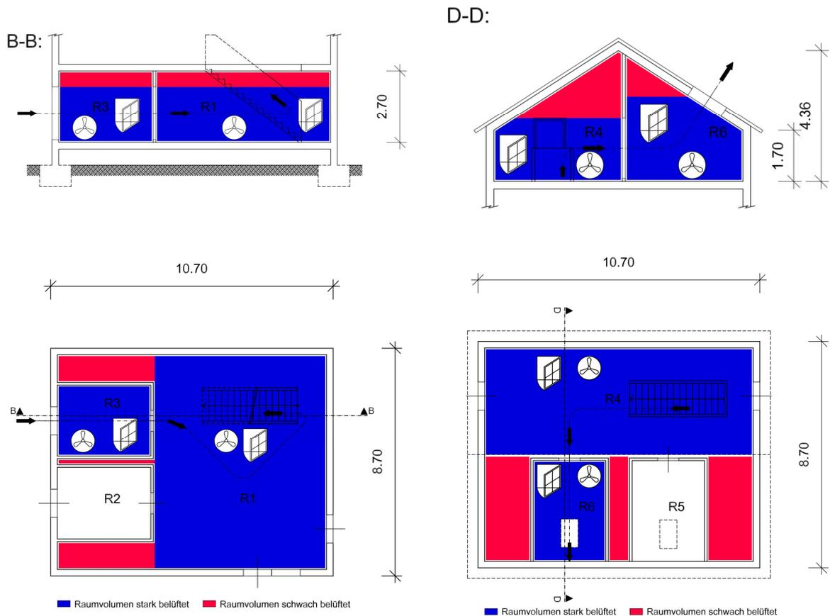
**Abb. 30:** durchmischtes Volumen im Grundriss EG (links unten) und Grundriss OG (links unten) sowie im Schnitt EG (links oben) und Schnitt OG (links oben). Ausbildung von stark und schwach belüfteten Bereichen
