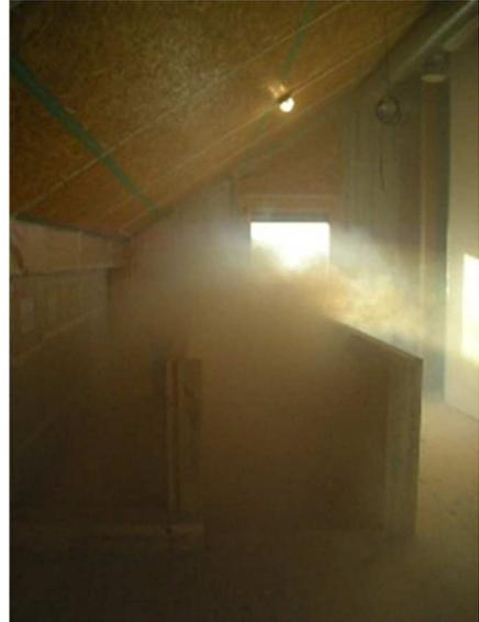
**Abb. 20: Verteilung des Nebels im untersuchten Raum, qualitative Untersuchung am 23.6.2014, Bild 1 (Bild links) und Bild 2 (rechts)**
