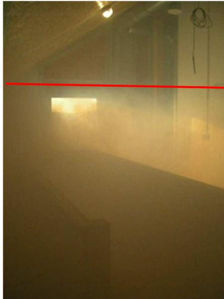
**Abb. 22: Ausbildung von stark und schwach belüfteten Bereichen. Der stärker vernebelte Bereich unterhalb der roten Trennlinie, gilt als stark belüftet. Der weniger stark vernebelte Bereich oberhalb der roten Trennlinie, gilt als schwach belüftet.**
