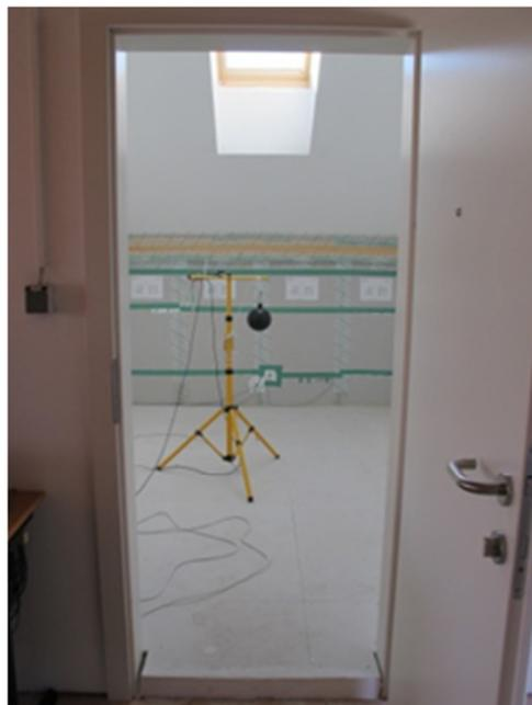
**Abb. 4: Bauphysikalisches Forschungshaus, Innenansicht, Messung der operativen Raumtemperatur und der Wandoberflächentemperatur, Quelle: (Teibinger et al. 2014)**
