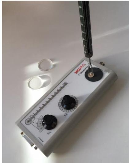
Abbildung 12: Messung der Abziehungskraft in Abhängigkeit von der Dicke der Kunststoffplättchen
