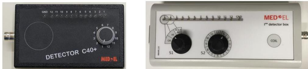
Abbildung 20: Die Detektor-Boxen des C40+ und PULSAR CI100 Implantats
