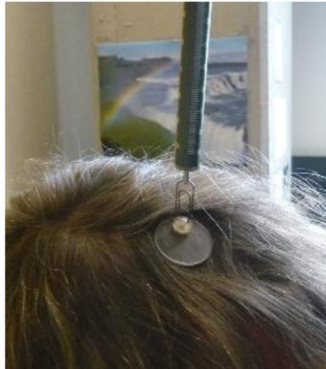
Abbildung 13: Messung der Hautlappendicke mit einer Federwaage mit verschiedenen Abständen (zwischen Implantat und Magnet werden verschiedenen dicke Kunststoffplättchen gelegt)
