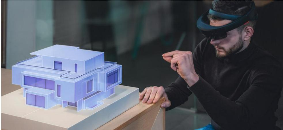
Abb. 31: die HoloLens MR-Smart Glasses bieten ein tragbares Display für ein durchsichtiges Seherlebnis (Intellectsoft, 2018)
