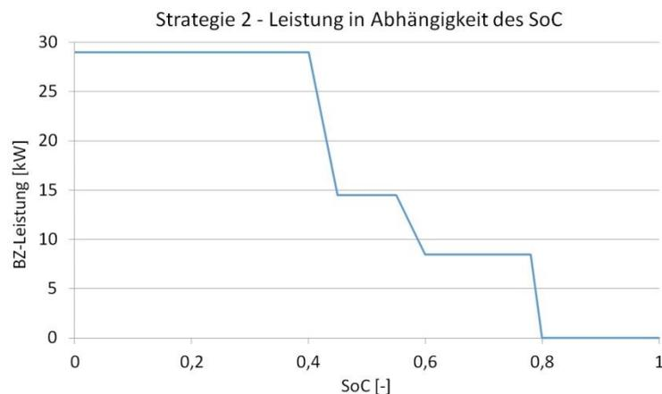
**Abbildung 5-8:** SoC-abhängige Brennstoffzellenleistung der Betriebsstrategie 2
