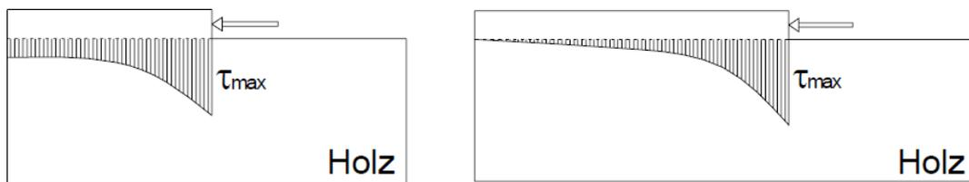
Abbildung 2.3 Verlauf der Schubspannung im Vorholz [2]
