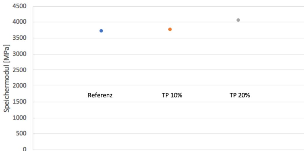
Abbildung 78: Speichermodul bei Raumtemperatur [23 °C] Testprodukt TP 2015088
