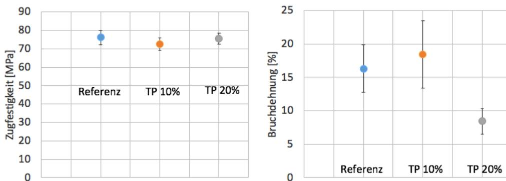
Abbildung 79: Ergebnisse Zugversuch Testprodukt TP2015088
