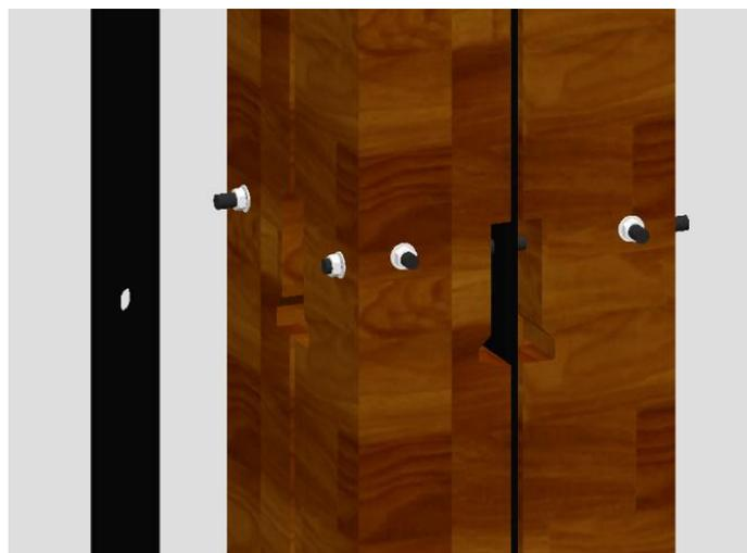
**Abbildung 44: Hybridstütze Durchbrüche**
