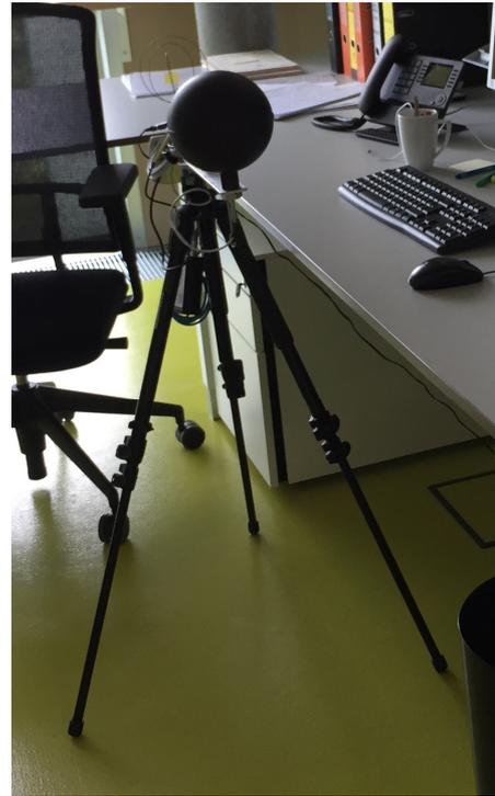
Abbildung 2: Schwarzkugelthermometer im Einsatz an einem Arbeitsplatz
