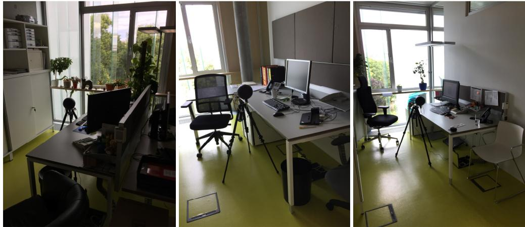
*Abbildung 11: Aufstellung des Messgeräts zur Messung der operativen Raumtemperatur und der Luftgeschwindigkeit in den Räumen N2, N1B und N1C*
