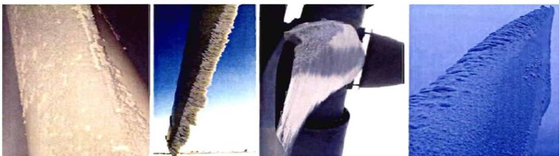
Figure 2.11 Airfoil shape altered by ice; Source: Système électrothermique de dégivrage pour une pale d'éolienne: simulations ensoufflerie réfrigérée et impact sur la puissance produite. Université Du Québec À Rimouski, Mayer C, 2007
