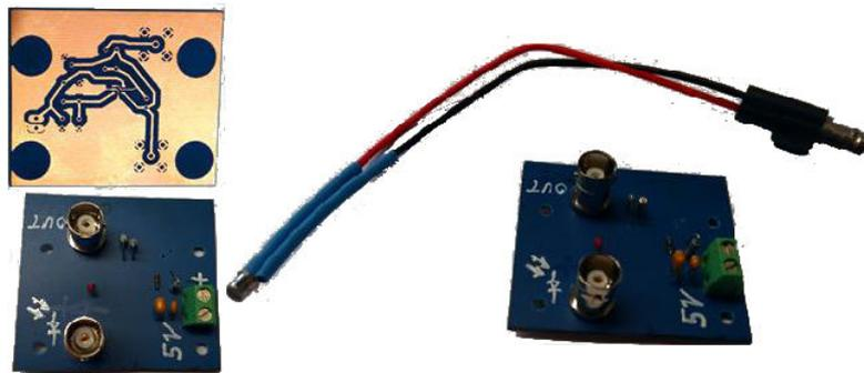
Abbildung 4.3: Photodiode mit Transimpedanzverstärker [11]
