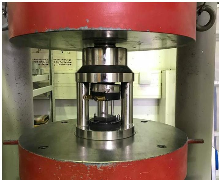
Abb. 17: Druckfestigkeitsversuch
