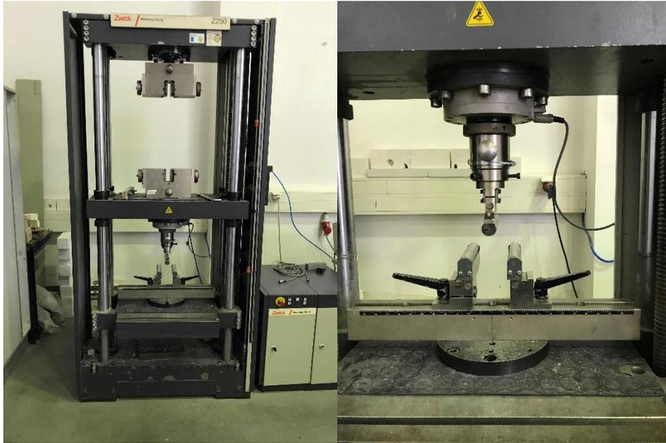
Abb. 45: Elektromechanische Prüfmaschine Zwick Z250
