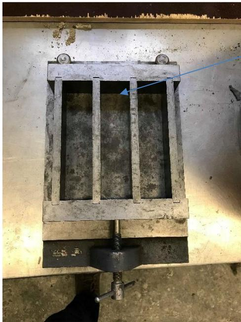
Prisma zur Untersuchung des Hydratationswärmeverlaufs
