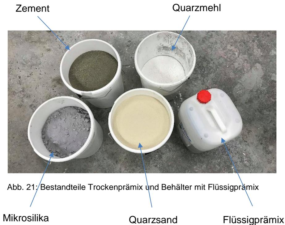
Abb. 21: Bestandteile Trockenprämix und Behälter mit Flüssigprämix
