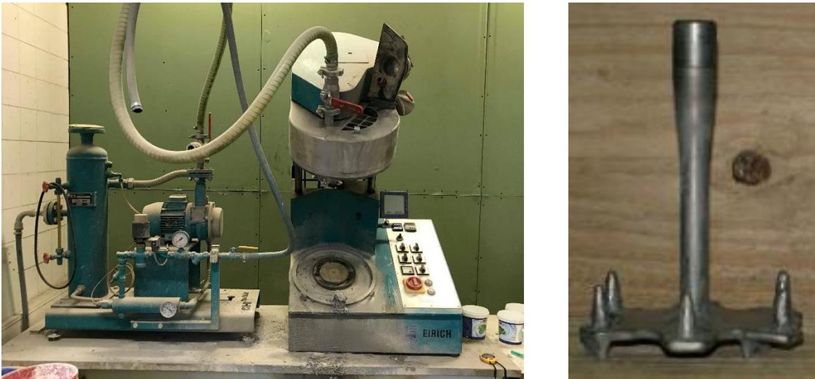
Abb. 24: Intensivmischer R02 Vac (links) und Stiftenwirbler<sup>53</sup> (rechts)
