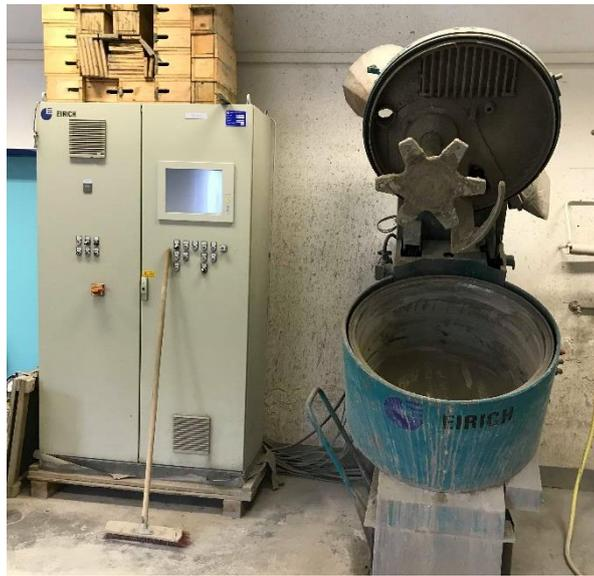
Abb. 22: Intensivmischer R08W der Fa. *Eirich*
