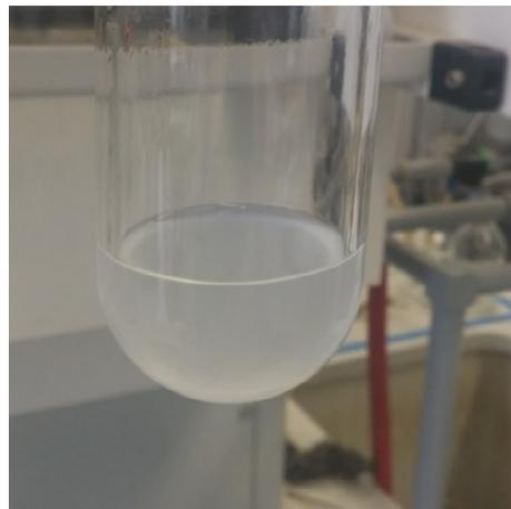
Abbildung 4-7: Trübung des Wasser- Butanol Gemisches bei Zugabe von Wasser
