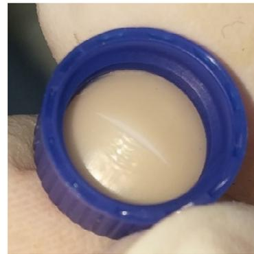
Abbildung 5-7: Unterseite der geschlitzten Vials nach Verwendung
