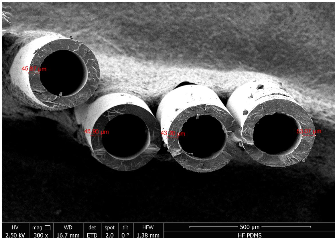
Abbildung 6-6: REM-Aufnahme der PDMS-Membran, Bestimmung der Schichtdicke
