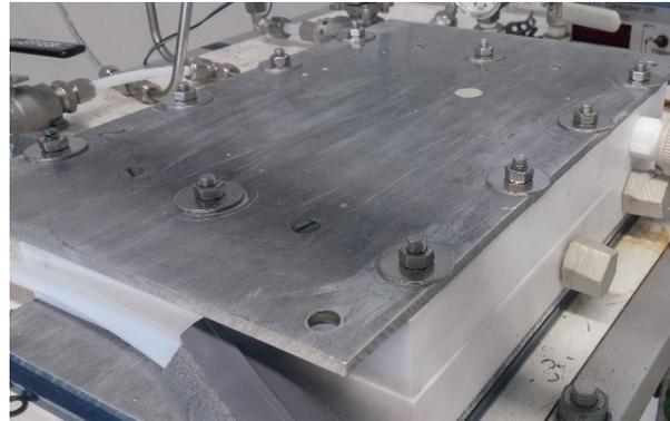
Abbildung 4-3: Flachmembranmodul
