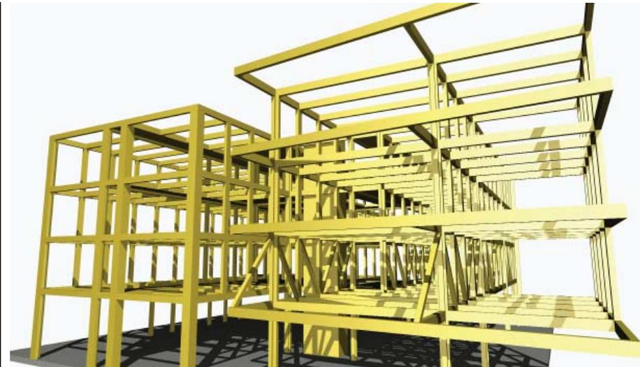
**Abb. 194-195** 3D Darstellung der Tragstruktur aus ArchiCAD
