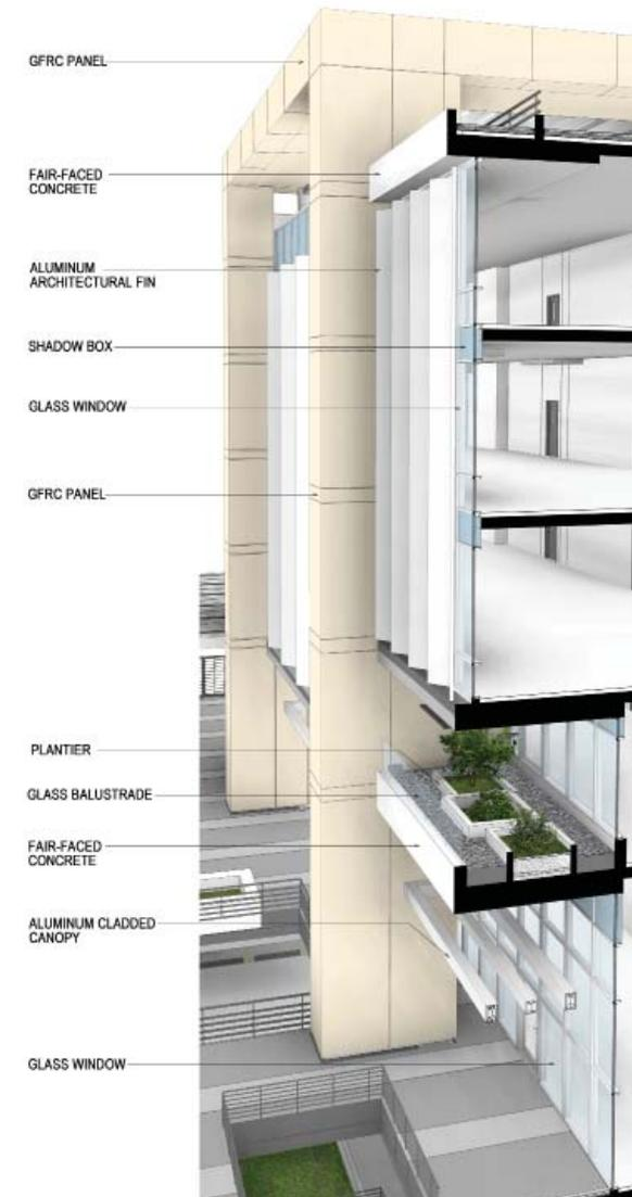
**Abb. 192** 3D Fassadenschnitt aus Revit dar al-handasah Projekt, Verfasser (2016)
