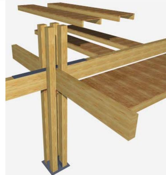
**Abb. 196** Deckenkonstruktion aus ArchiCAD
