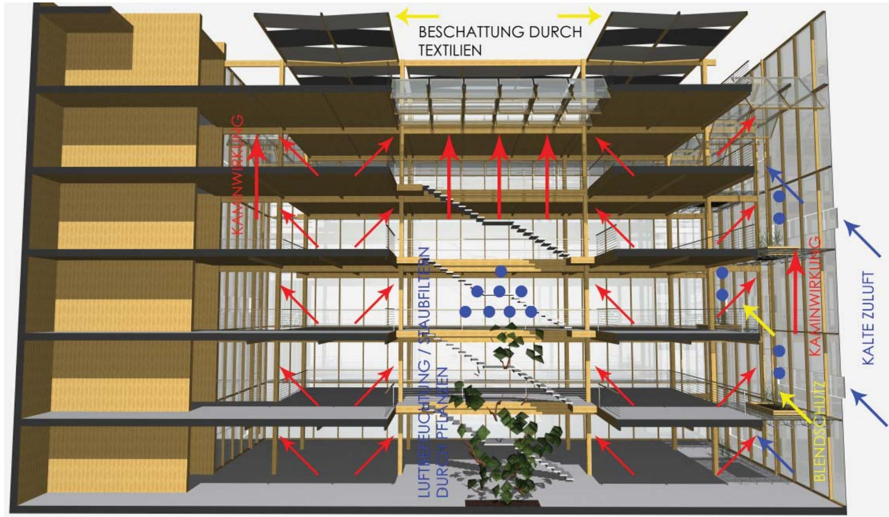
**Abb. 215** Klimakonzept-Querschnitt: das Gebäude soll ohne Klimaanlage auskommen; großes Volumina und kleine Luftwechselrate, thermische Dynamik, natürliche Belüftung und Befeuchtung, Sonnenschutz sowie Blendschutz
