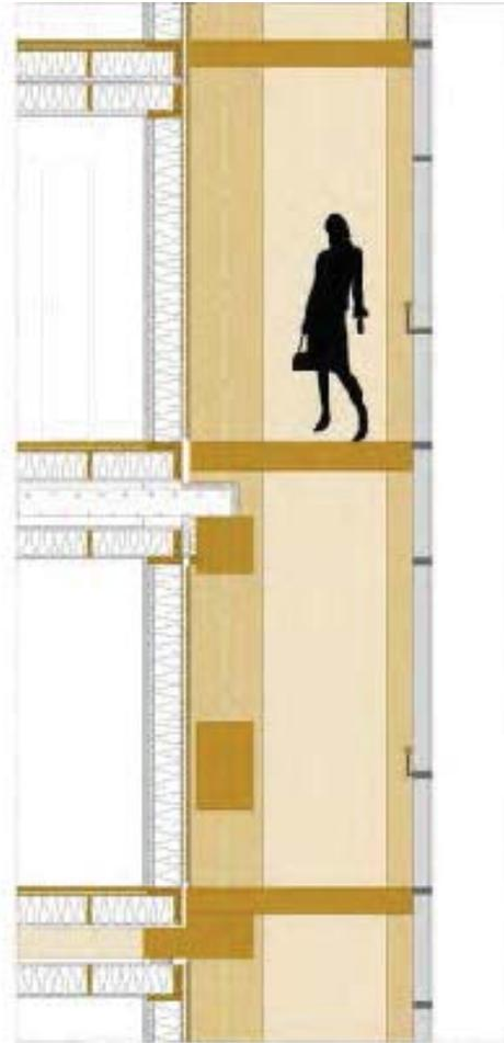
**Abb. 114** Die Balkone sind ein Unterstützungssystem für die Glasfassade - hauptsächlich hängen sie in zwei großen Brett-schichtholz-balken. Balkonplatten werden aus CLT hergestellt und sind zwischen CLT-Platten gespannt, die mit den Stützen verbunden sind. Böden, Wände und Decken sind aus ungeschütztes unbehandeltes CLT.
