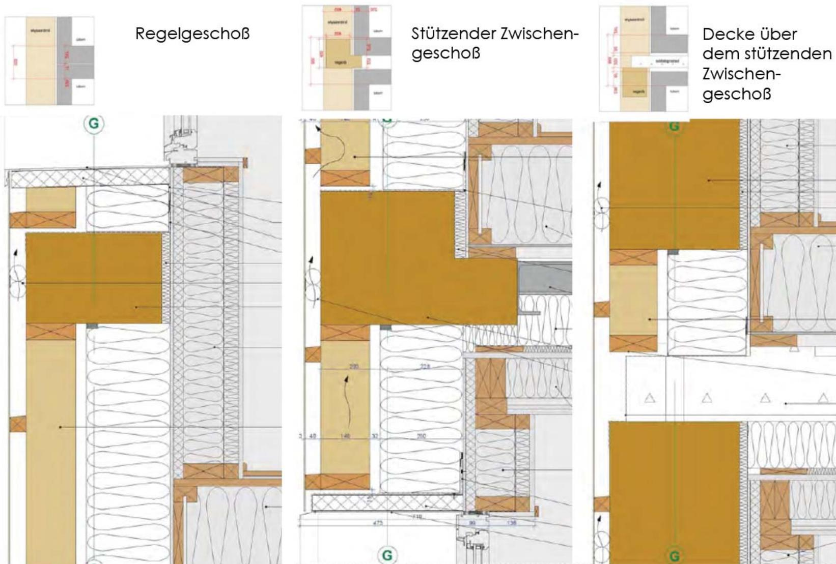
**Abb. 112** Giebelwanddetail - Feuer-, Wetter- und Schallschutz
