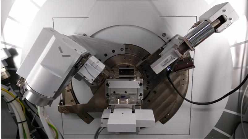
Abbildung 5.3: Foto der Messanordnung zur Quantifizierung des Höhenfehlers mittels PB-Optik.
