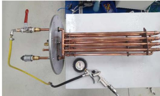
Abbildung 5.2: Seifenblasentest am Kondensatorwärmetauscher
