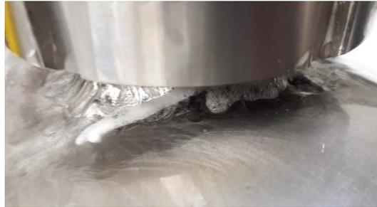
Abbildung 5.3: Seifenblasenbildung an undichter Pore einer Schweißnaht
