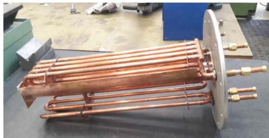
Abbildung 4.4: Kondensator, Kondensatwanne und Generator
