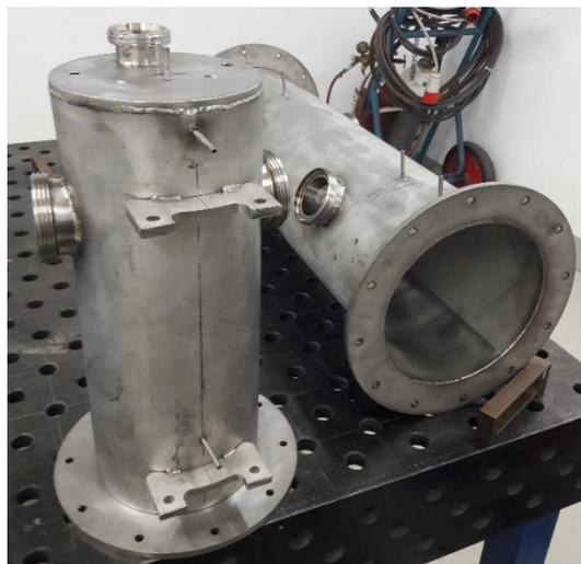
Abbildung 4.7: Generator-/Kondensatorbehälter (links) und Absorber-/Verdampferbehälter (rechts)
