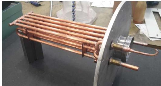
Abbildung 4.6: Verdampferberieselung und Verdampfer
