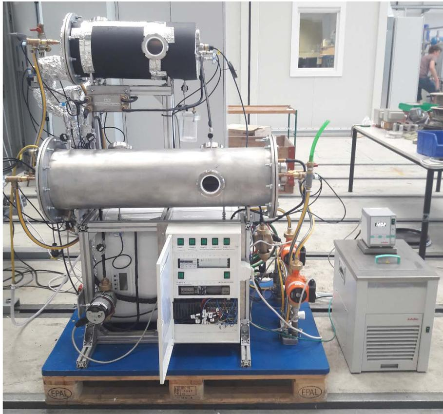
Abbildung 9.3: Isolierte Absorptionskältemaschine mit Thermostat für Kaltwasserversorgung
