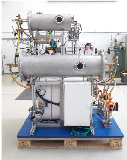
Abbildung 4.8: Absorptionskältemaschine vor dem Anbringen der Isolierung
