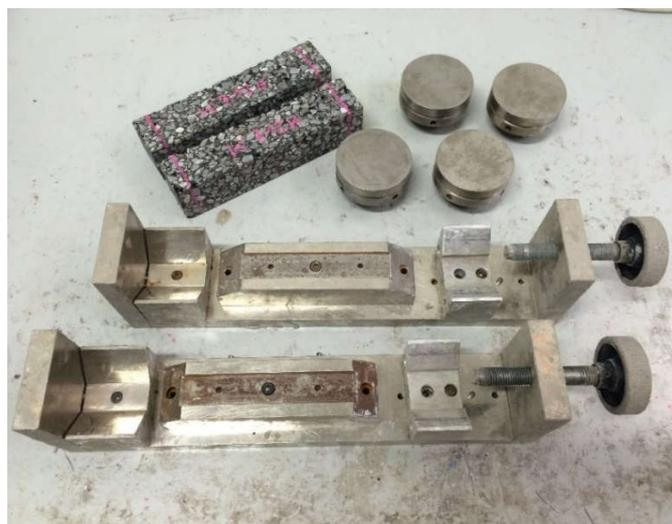
Abb. 25:Montagebank, Stahladapter und Probekörper [43]
