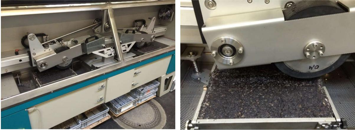
Abb. 9: Prüfaufbau des Spurbildungstests [43]
