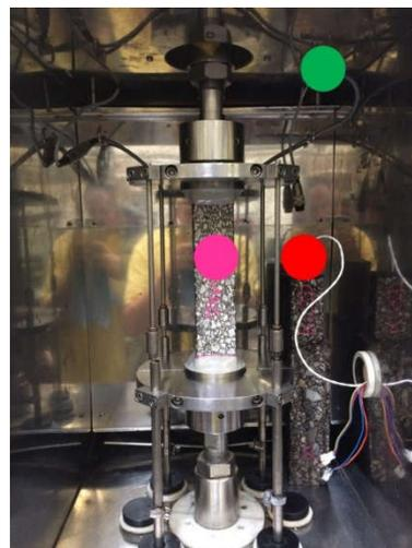
Abb. 50: Position Temperatursensoren Kälte-ALT [43]
