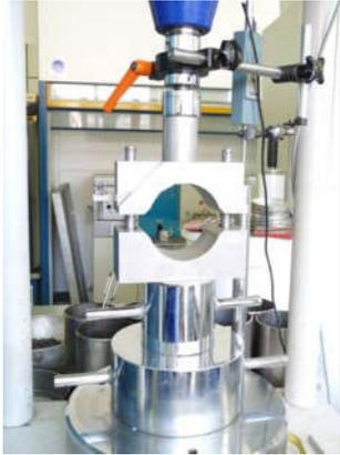
Abb. 10: Versuchsaufbau Marshall Prüfung [43]
