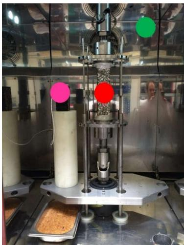
Abb. 49: Position Temperatursensoren Kälte-NEU [43]
