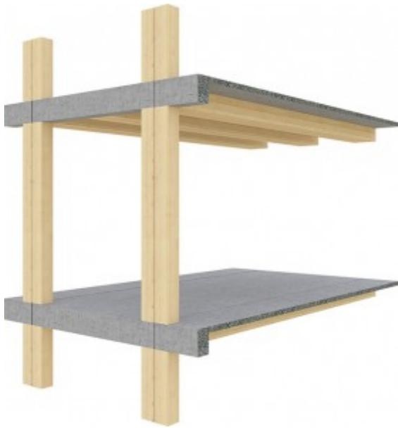
Abbildung 29: LCT System bestehend aus BSH- Stützen und Holz- Beton- Verbunddecke
