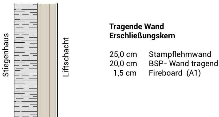
Abbildung 101: Wandaufbau im Stiegenhaus- Brandlastfreies Stiegenhaus durch Stampflehm und Gipsbeplankung; © Bernhard Bauer
