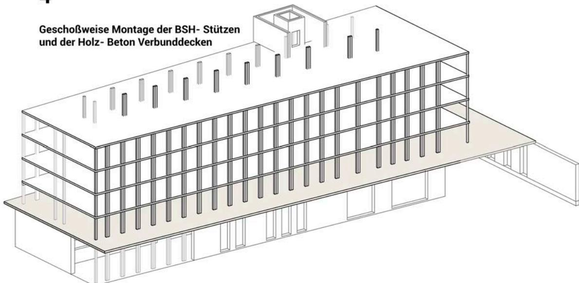
Abbildung 75: Geschoßweise Montage der Tragstruktur bestehend aus BSH- Stützen und Holz- Beton Verbunddecken; © Bernhard Bauer
