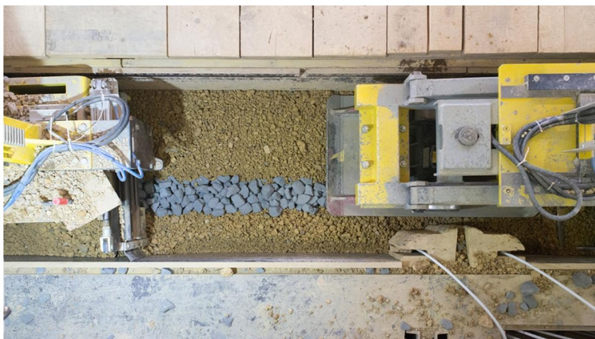
Abbildung 43: Herstellung der zweischaligen, gedämmten Stampflehmwand
