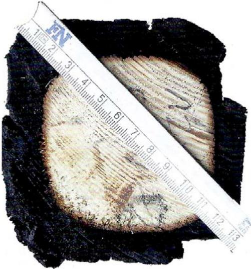
Abbildung 95: Querschnitt Vollholzbalken nach Brandbeanspruchung. Im Gegensatz zur eindimensionalen Abbrandrate  $\beta_0$ , welche die Abbrandtiefe in der Mitte eines Holzquerschnitts abbildet, berücksichtigt die nominelle Abbrandrate  $\beta_n$  Eckausrundungen beim Abbrennen des Querschnitts und Risse im Holz
