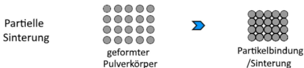
Abbildung 8: Schematische Darstellung der partiellen Sinterung nach Ohji und Fukushima. [15]
