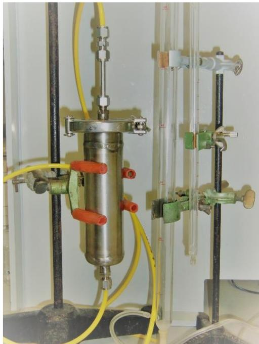
Abbildung 18: Messapparatur zur Bestimmung der Permeabilität
