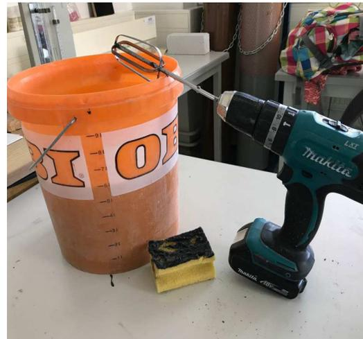
Abbildung 4-14: Akkubohrer mit Mischwerkzeug
