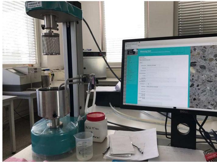
Abbildung 4-2: Viskomat mit Doppelringspalt-Messzelle
