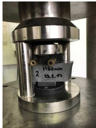
Abbildung 4-8: Druckfestigkeitsprüfung
