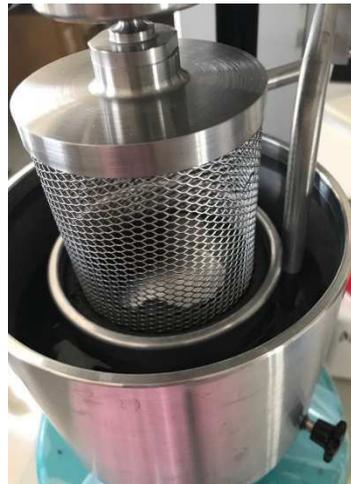
Abbildung 4-13: Aufnahme Rheometer
