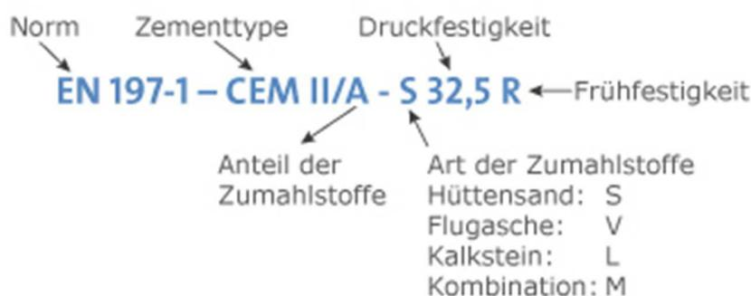
Abbildung 2-3: genormte Zementbezeichnung<sup>4</sup>
