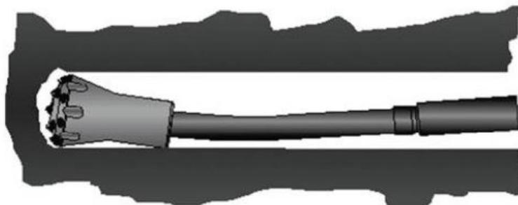
Abb. 2.31: Setzungsbedingte Abweichung einer Bohrung nach oben [62]
