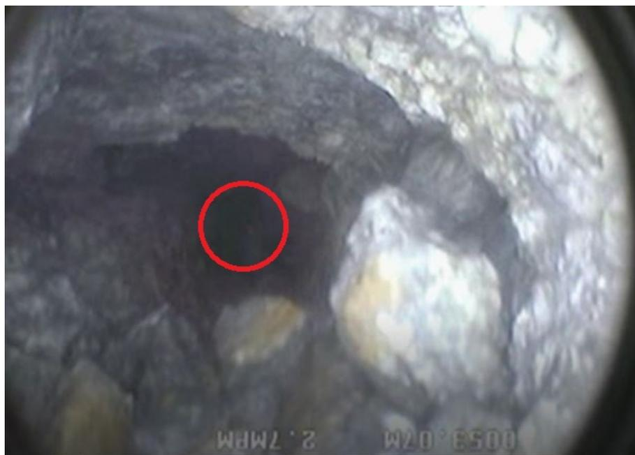
**Abb. 1.7:** Optische Merkmale des Gebirgsbereichs C (der rote Ring stellt das ursprüngliche Bohrloch dar) [87]
