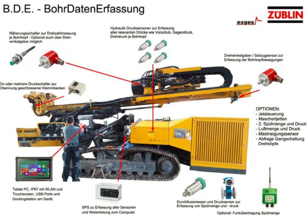
Abb. 1.2: Komponenten der Bohrdatenerfassung und ihre Anordnung am Bohrgerät [100]
