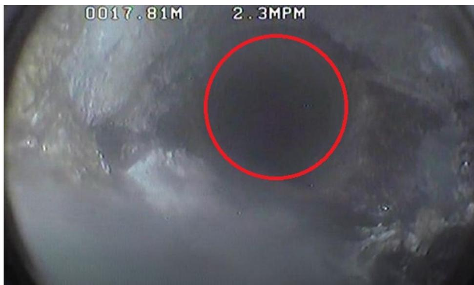
**Abb. 1.9:** Zu den abgebildeten Bohrdaten gehörige Aufweitung des Bohrlochs (der rote Ring entspricht dem ursprünglichen Bohrlochdurchmesser) [87]
