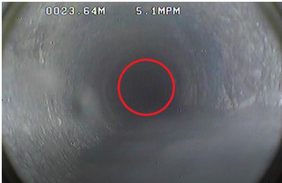
**Abb. 1.5:** Optische Merkmale des Gebirgsbereichs A (der rote Ring stellt das ursprüngliche Bohrloch dar) [87]
