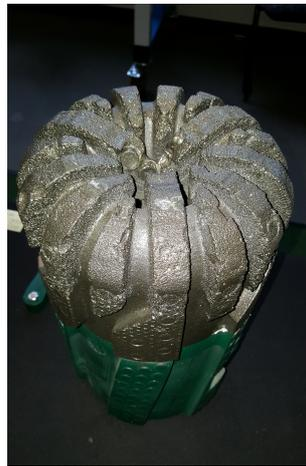
**Abb. 2.14:** Imprägnierter Diamantmeißel [48]
