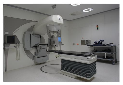
Figure 3.1: LINAC Elekta Synergy<sup>®</sup> S at the Salzkammergut-Klinikum Vöcklabruck
