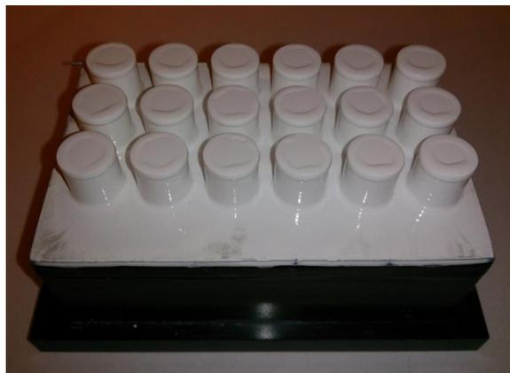
Abbildung 18: Vollzylinder Z2-MS31\_42-1P-s auf Bauplattform, fehlerfreie Herstellung aller Zylinder
