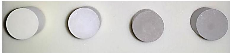
Abbildung 45: Farbveränderung von Vollzylinder aus A3-MS13B nach TMA – Versuchen bis zu unterschiedlichen Temperaturen v.l.n.r. 150°C, 200°C, 250°C, 300°C
