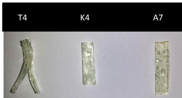
Abbildung 23: Zerstörungsformen von Polymerstäbchen MS31 nach Behandlung mit unterschiedlichen RM
