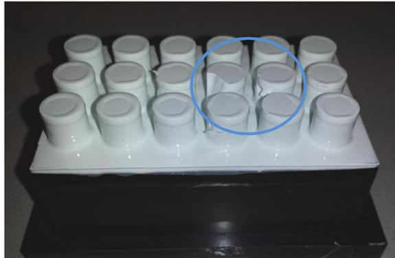
Abbildung 17: Vollzylinder Z2-MS31\_42-1P-s auf Bauplattform, teilweise unvollständiger Bau der Zylinder, Grund dafür ist die Überpolymerisation
