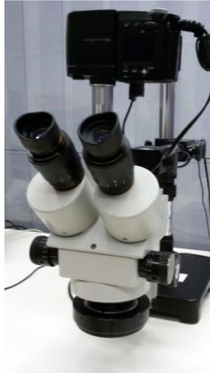
*Abbildung 33: Stereomikroskop Krüss*
