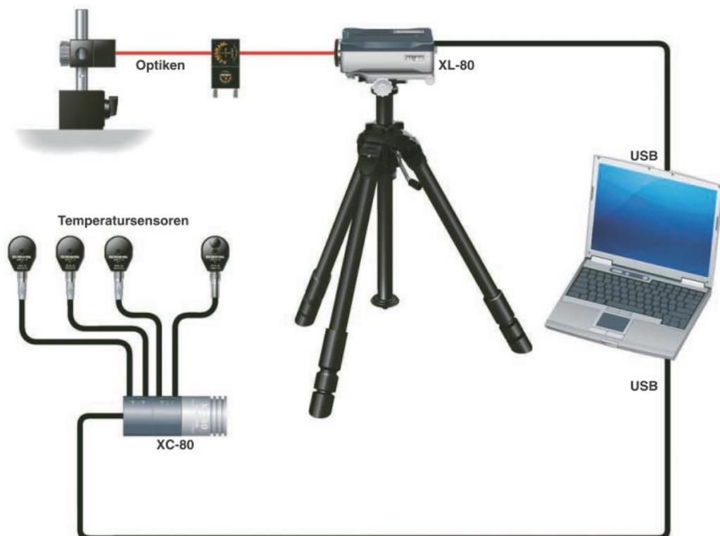
Abbildung 30: Funktionsprinzip Laserinterferometer (vgl. [49], S. 6)
