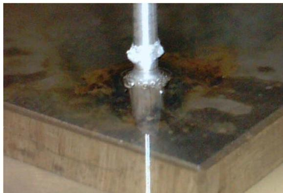
Abbildung 85: Bearbeitung von 1.2343 in 2 M  $\text{NaNO}_3$  (Versuch Nr. 140)
