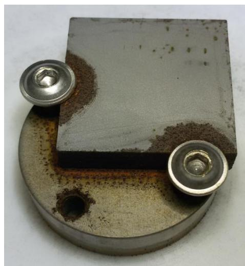
Abbildung 90: Korrosion am Werkstück (1.2343) nach elektrochemischer Bearbeitung mit HCl als Elektrolyt
