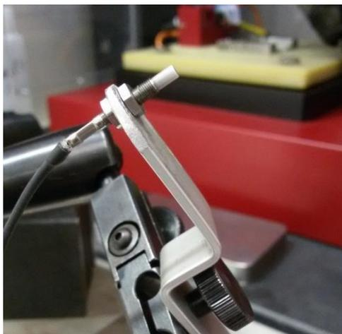
*Eddy-Sensor (Messbereich  $0,5 \text{ mm}$ ) mit
