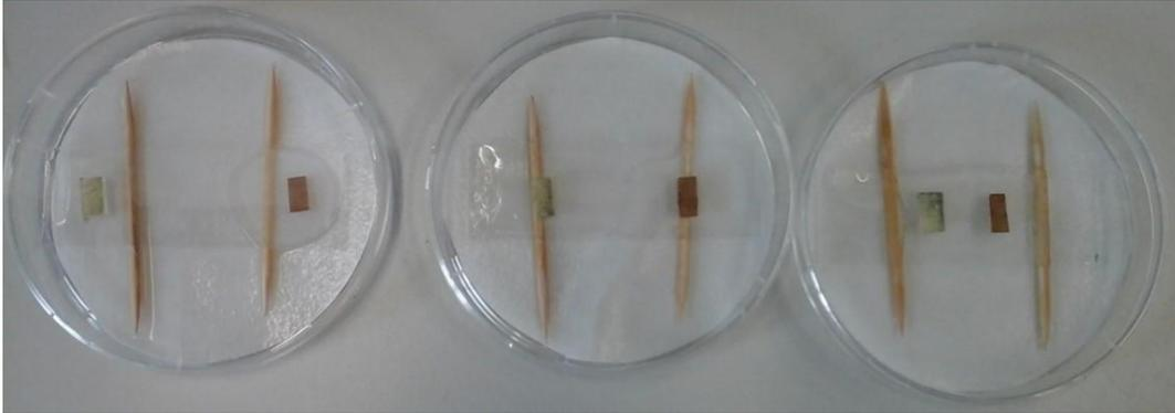
Abbildung 15: Aufbringung von *Trichoderma* (rechts) und *Rhizoctonia* (links) in unterschiedlichen Abständen auf ITO-Targets inkl. Platzierung dieser in Petrischalen
