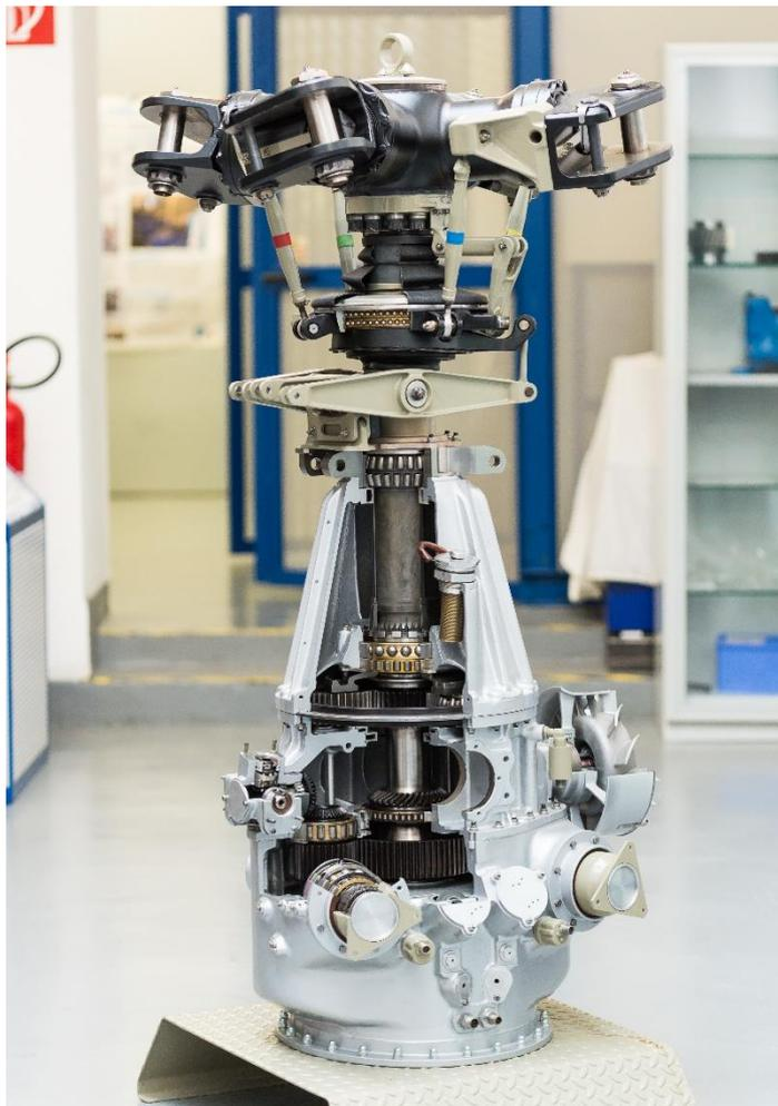
**Abbildung 5: Hauptgetriebe des Hubschraubers BO-105 [K. Hartenthaler]**
