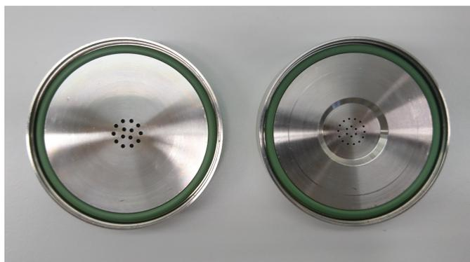
Abbildung 5.8: *Punktmuster der 2 kleineren Stufen. Links: Partikelgröße  $2,5\mu\text{m} - 10\mu\text{m}$ ; Rechts: Partikelgröße von  $1\mu\text{m} - 2,5\mu\text{m}$*
