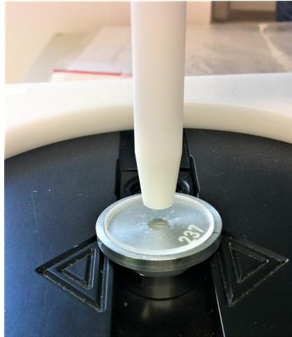
Abbildung 5.10: Nanoliterapplikationseinheit beim Aufbringen der Kalibrierstandards im Punktmuster
