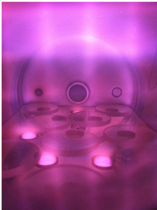
Abbildung 5.7: *Reflektoren im Plasma während des Plasmaaschvorgangs*
