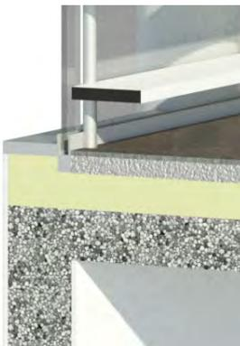
3. Anschluß Innenwand und Fassadenverglasung
