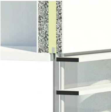
2. Anschluß STB-Fertigteile, Fassadenverglasung und
