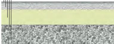
4. Dichtbeton-Plattenfundament, unterseitig gedämmt,
