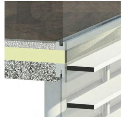
5. Anschluß Bodenplatte, Fassadenverglasung, Geländer und Abdeckprofil (Glas)
