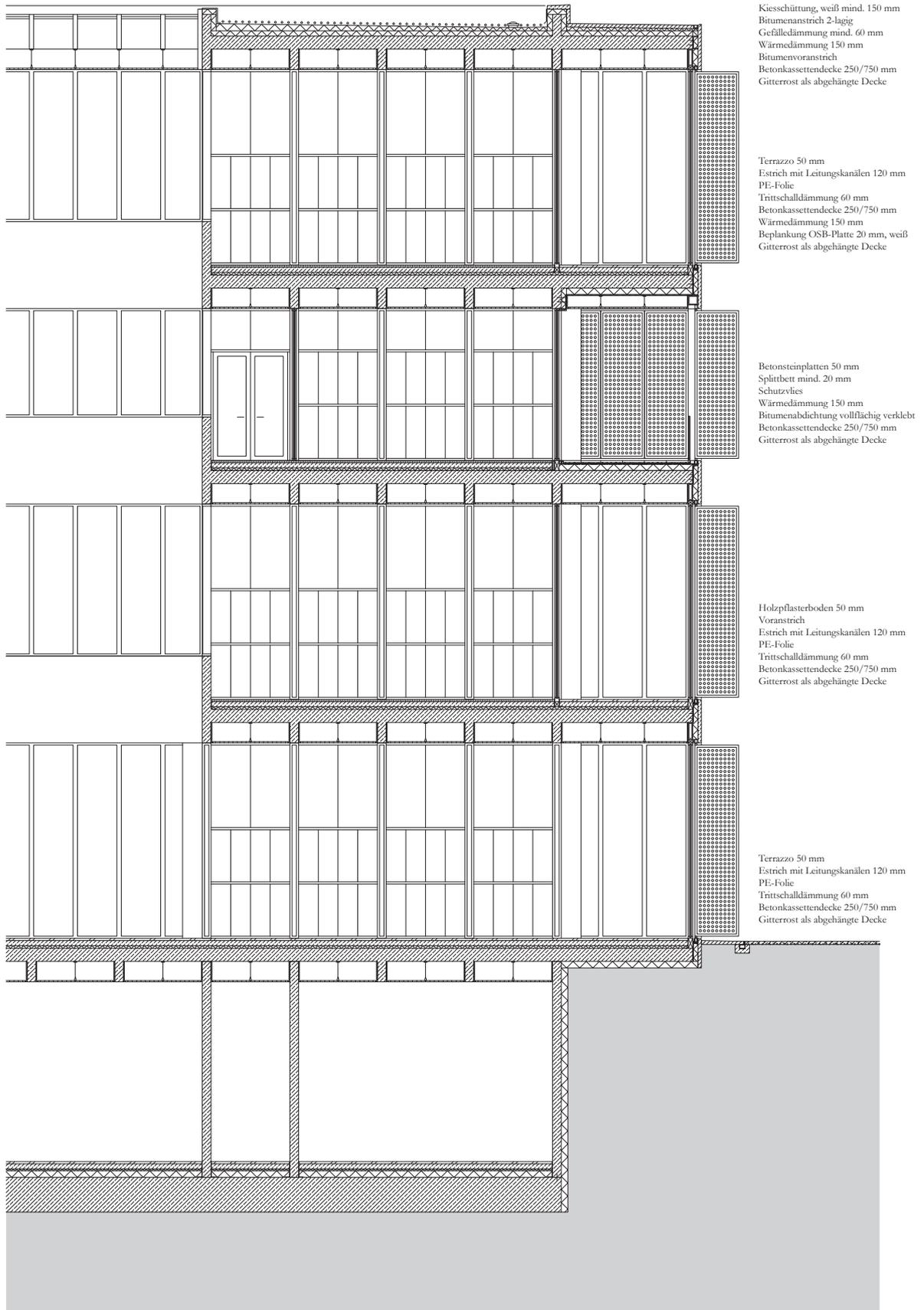
Abb. 46 Werkhaus Fassadenschnitt
