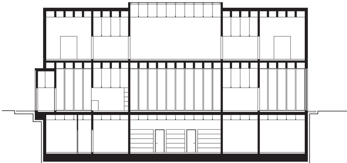
Abb. 55 Ausstellungspavillon Schnitt 2 - quer durch den zentralen Ausstellungsraum
