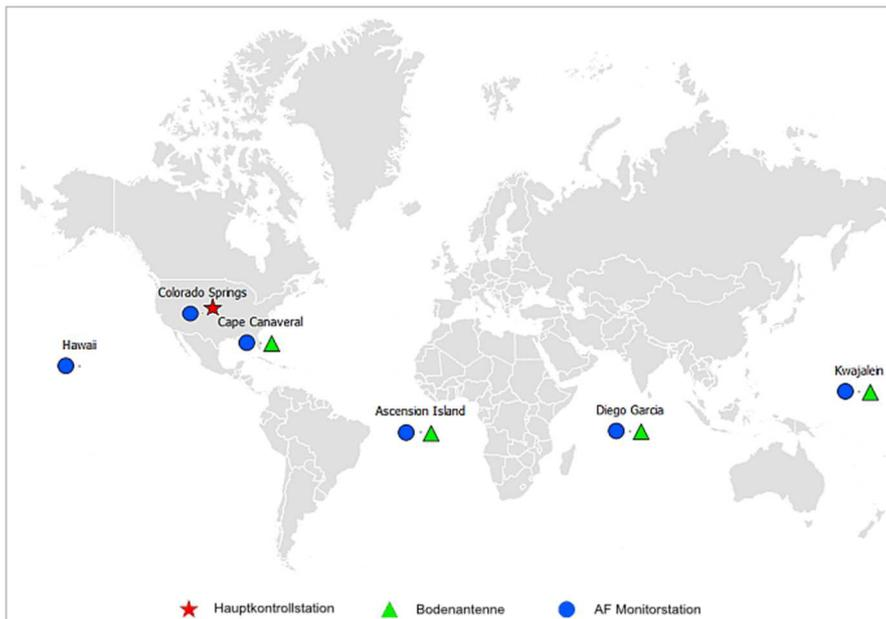
Abbildung 2.1.2.1 - GPS Kontrollsegment
