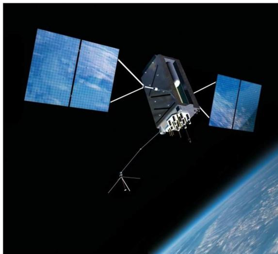
*Abbildung 2.1.1.1 - Block IIIA GPS - Satellit*
