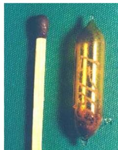
**Abb.1:** In Suprasil-Glasphiole eingeschweißte Probe (Quelle: HMI Berlin, <http://portal.uni-freiburg.de/janiak/Lehre/ac-pdf/vl22>)
