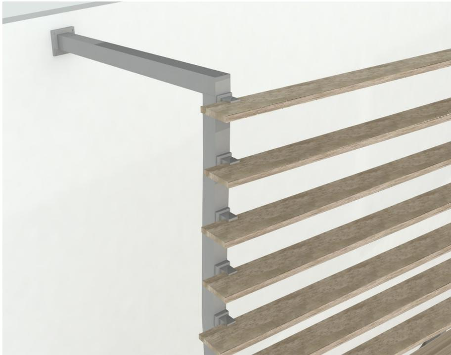
7.3.1.2. Anschluss des starren Lamellensystems an den Stahlstehern
