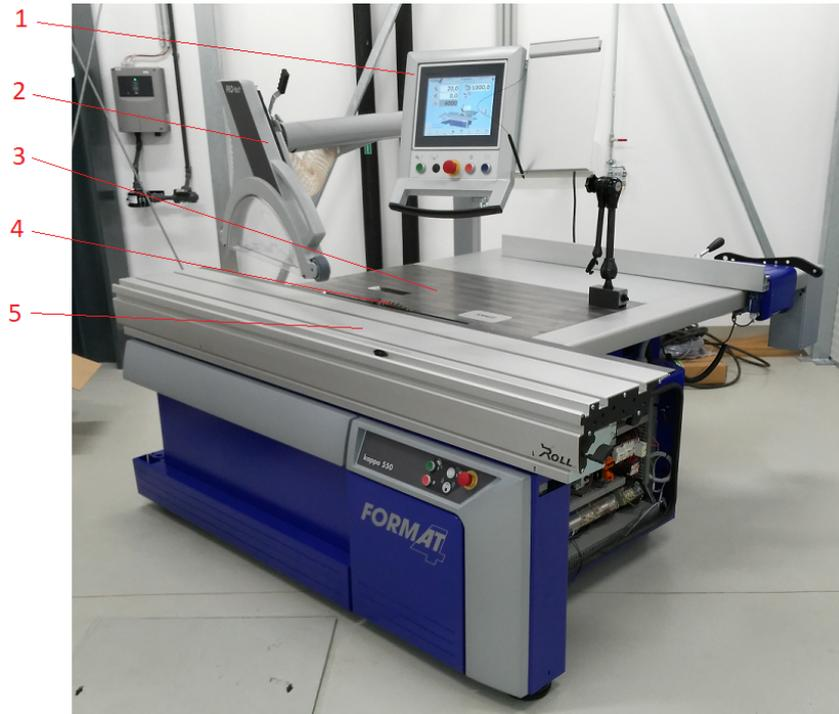
Abbildung 2.1.: Kreissäge *Felder Format 4 Kappa 550* am IFT. Die Kreissäge besteht dabei aus dem Rechnerpanel (1), der Staubabsaugereinrichtung (2), dem Arbeitstisch (3) aus Stahl, dem abzusenkenden Kreissägeblatt (4) und dem Vorschubtisch (5).
