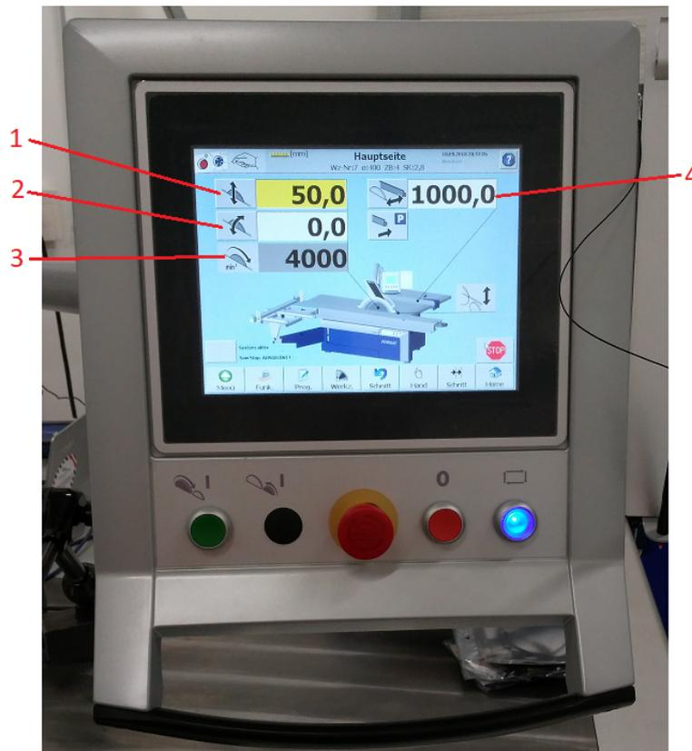
Abbildung 2.5.: Integriertes Rechnerpaneel der *FELDER FORMAT 4 Kappa 550*: Die dabei wichtigsten Einstellungen sind die Schnitttiefe (1), der Schnittwinkel (2), die Drehzahl (3) und der Parallelanschlag des Sägeblatts. [Foto: Matti Felsner]
