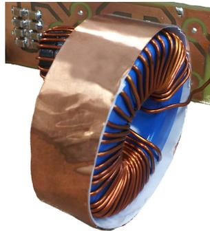
Abbildung 4.7: Kurzschlussring auf der Sendust 571 Drossel.
