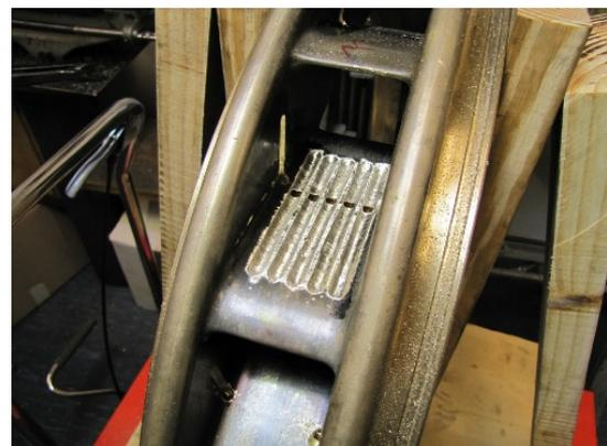
**Abbildung 3.8:** Manuell hergestellte Einfräsungen im Stützring.
