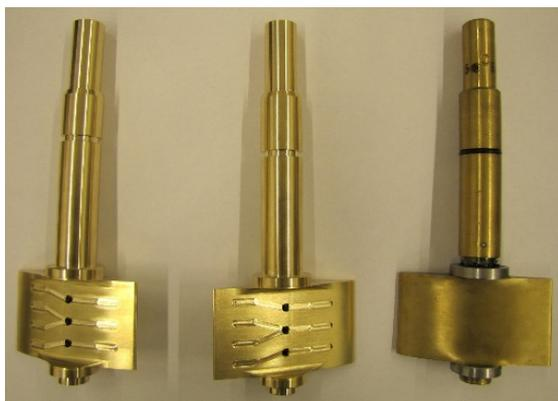
**Abbildung 3.7:** Leitschaufeln der Modell-turbine.
