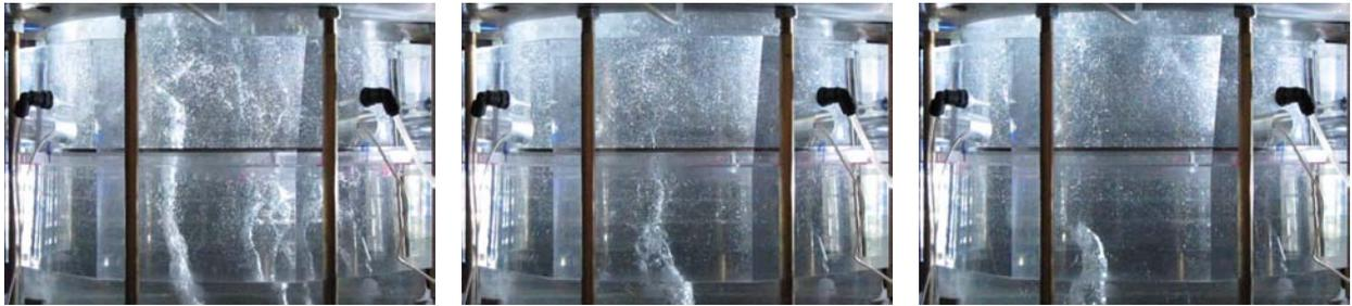
Abbildung 4.26: Wirbelstrukturen im Diffusor bei  $Q_{ED}/Q_{ED,BEP} = 0.4$  aus [18].
