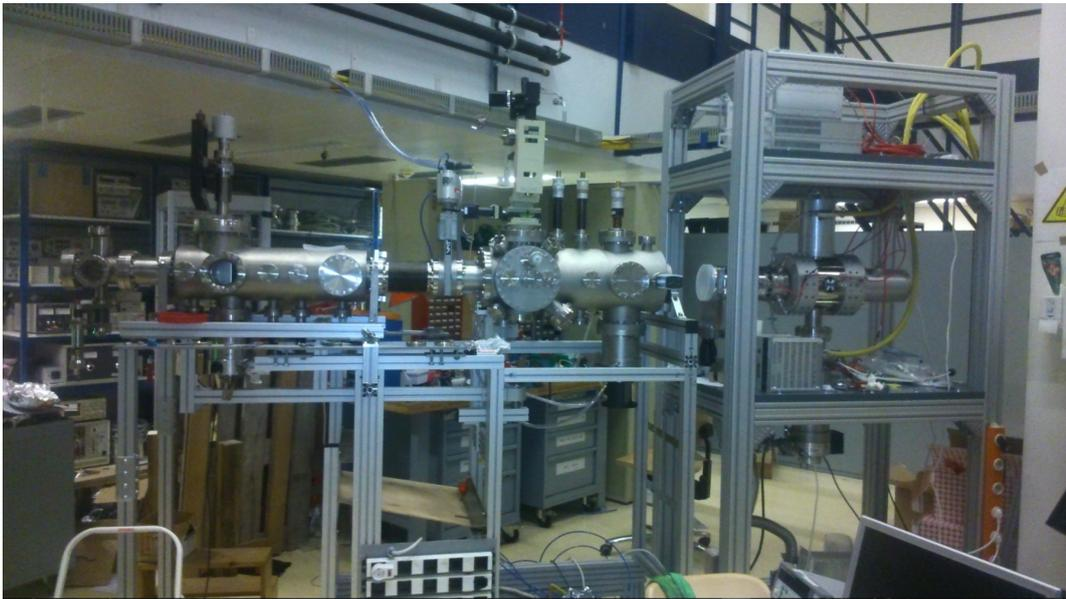
Abbildung 5.3: Einbau der Time-of-Flight Kammer an die Targetkammer.
