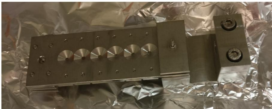
Abbildung 3.9: Targethalter mit bis zu 6 verschiedenen Targets und einem Farraday-Cup ganz links im Bild.
