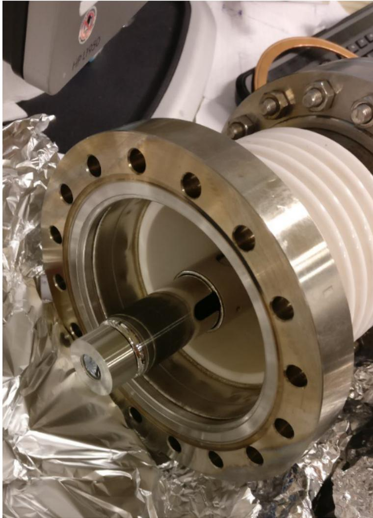
Abbildung 3.7: Bild des PIPS-Detektors.
