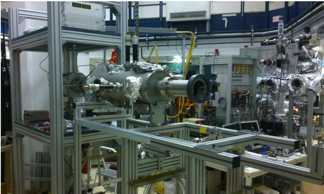
Abbildung 5.2: Anbau der Targetkammer an die Ionenquelle.
