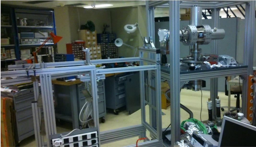
Abbildung 5.1: Als erstes wurde beim NIELS Experiment die Ionenquelle Dreebit EBIS-A eingebaut.
