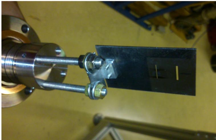
Abbildung 5.4: Beim horizontalen Schlitz kann zwischen zwei verschiedenen Schlitzbreiten ausgewählt werden.
