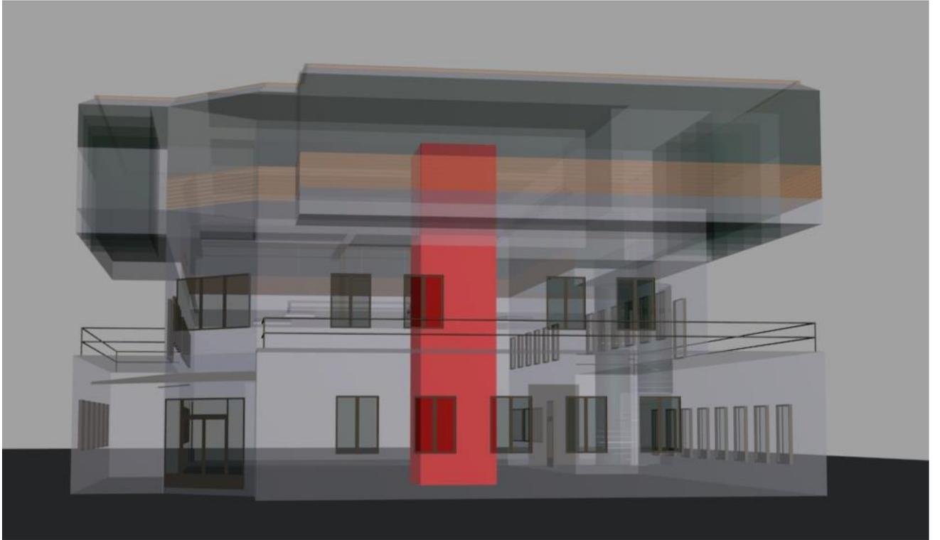
Abbildung 36: Haupthaus Aufzugsanimation durch die bestehende Dachkuppel
