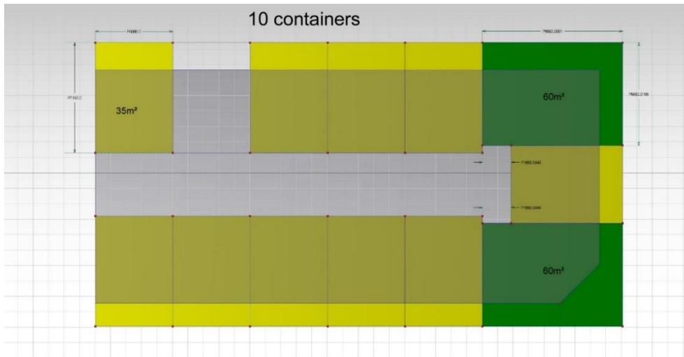
Abbildung 12: Raum-, und Flächenberechnung der Aufstellungsmöglichkeiten 10 Container 35 m<sup>2</sup> plus Sozialräume mit gesamtter Fläche von 470 m<sup>2</sup> und Mittelgang/Abgang Stiegen Fläche Zugang
