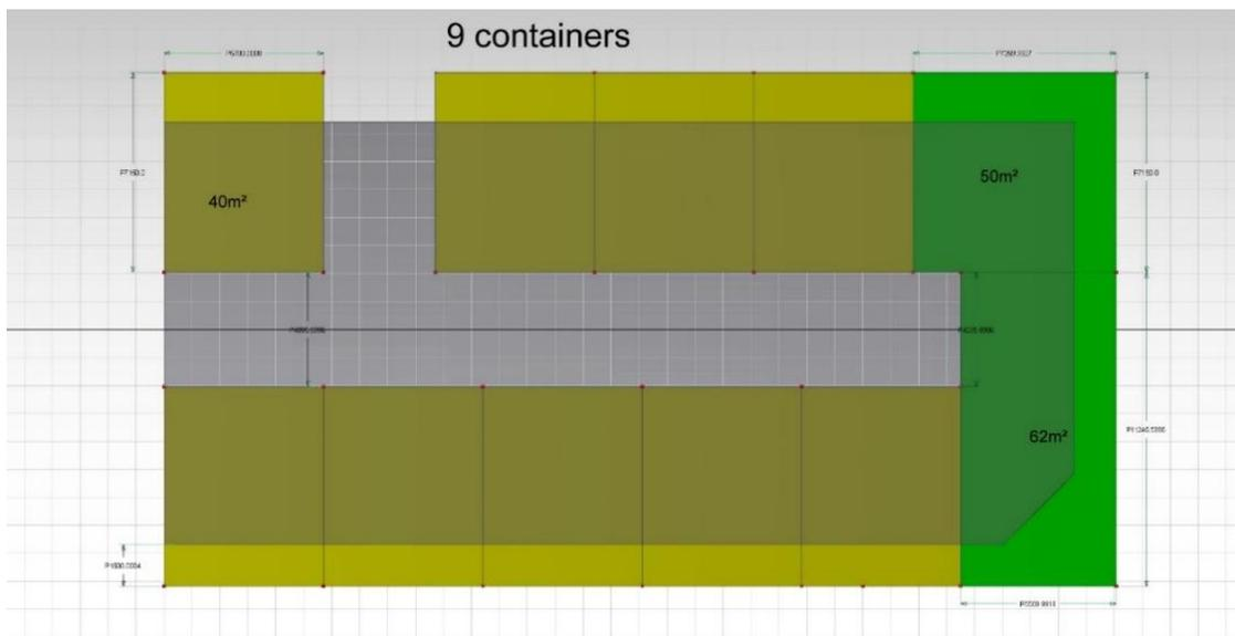
Abbildung 11: Raum-, und Flächenberechnung der Aufstellungsmöglichkeiten 9 Container 40 m2 plus Sozialräume mit gesamtter Fläche von 472 m2 und Mittelgang/Abgang Stiegen Fläche Zugang
