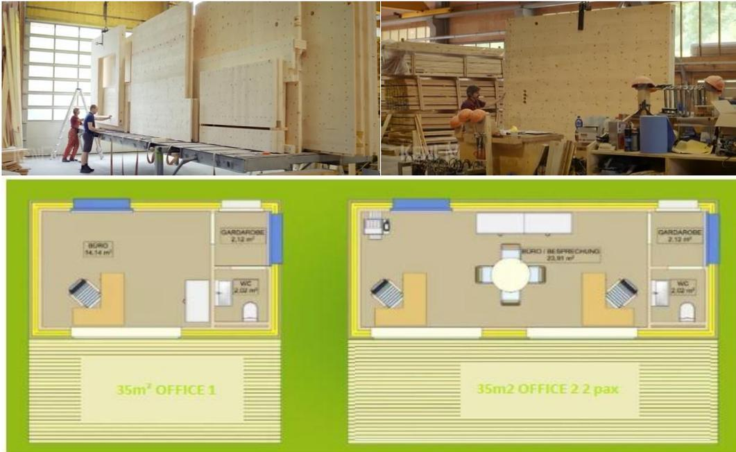
Abbildung 46: Thoma-Holzwerk versteinerte/mehrlagige Vollholzbauweise in einer baustellengerechten Vorfertigung-Holzriegelbauweise – Design Mc Cube
