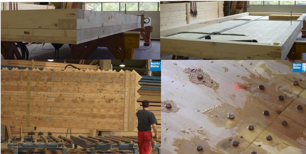
Abbildung 47: Thoma-Holzwerk versteinerte/mehrlagige Vollholzbauweise in einer baustellengerechten Vorfertigung-Holzriegelbauweise
