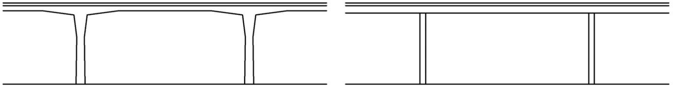
**Bild 1** Unterbau und Überbau als eine zusammenhängende (links) und getrennte (rechts) Funktionseinheit
