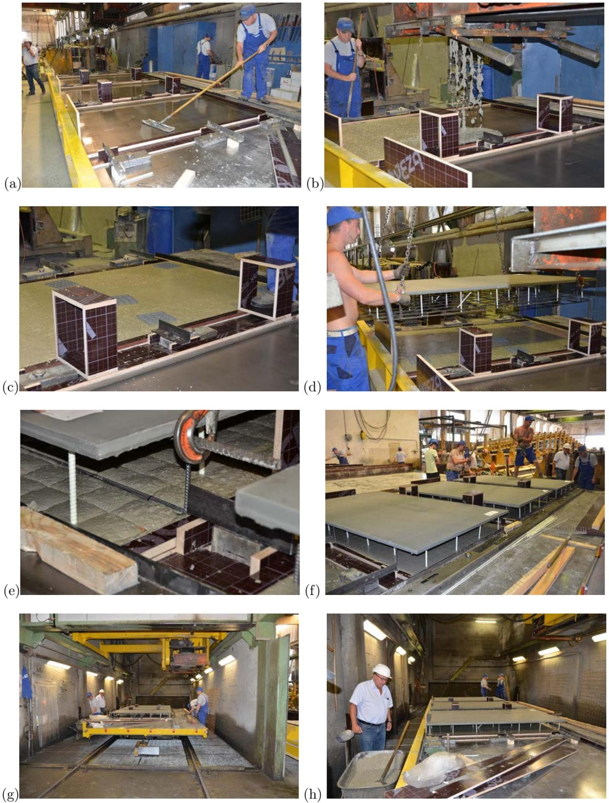
Abbildung 4.11.: Betonieren der zweiten Wandplatten aus Normalbeton und Einsetzen der Bewehrungskörbe (a-h)
