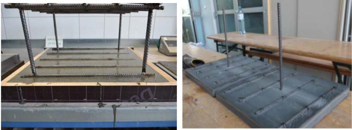
Abbildung 1.1.: Versuchskörper für Scherversuche (li.) und Ausziehversuche (re.) [2]
