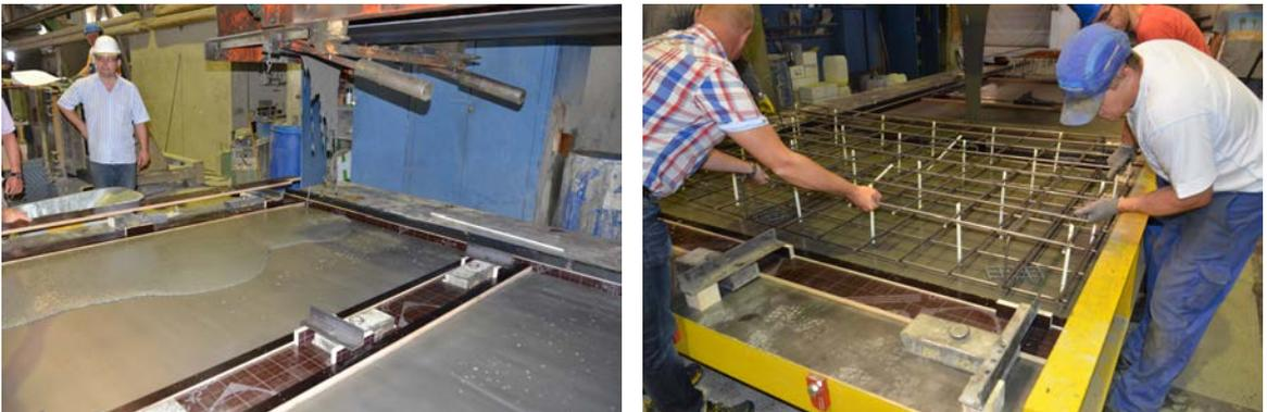
Abbildung 4.6.: Betonieren der ersten Wandplatten aus UHPC (links) und Einsetzen der Bewehrungskörbe (rechts)
