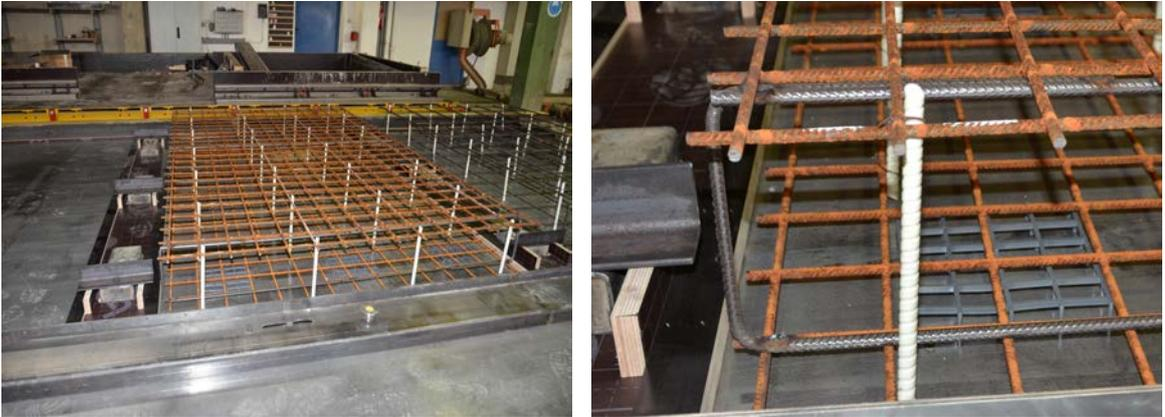
Abbildung 4.1.: Bewehrungskorb Prototyp 1 - Ø8,2/10mm
