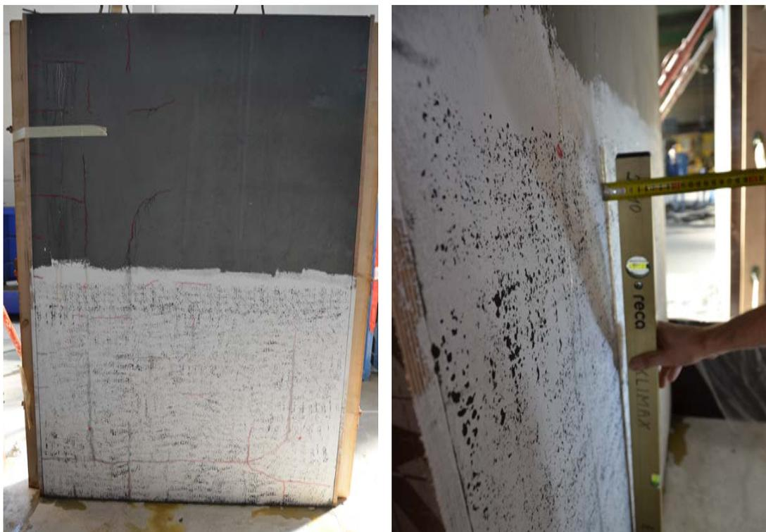
Abbildung 6.1.: Schwind- und Biegerisse (li.), Verformung Prototyp 3 (re.)
