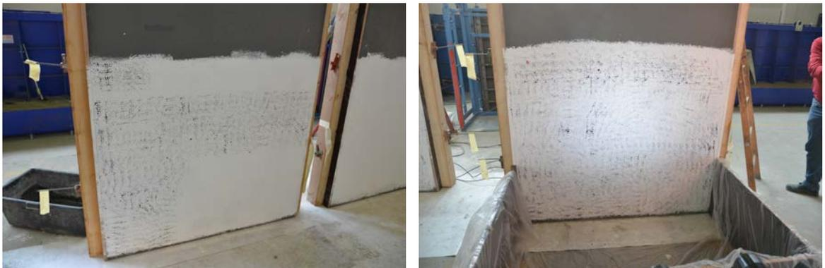
Abbildung 5.4.: gesprenkelte Oberfläche der Prototypen (li.) und Schutzvorrichtung (re.)
