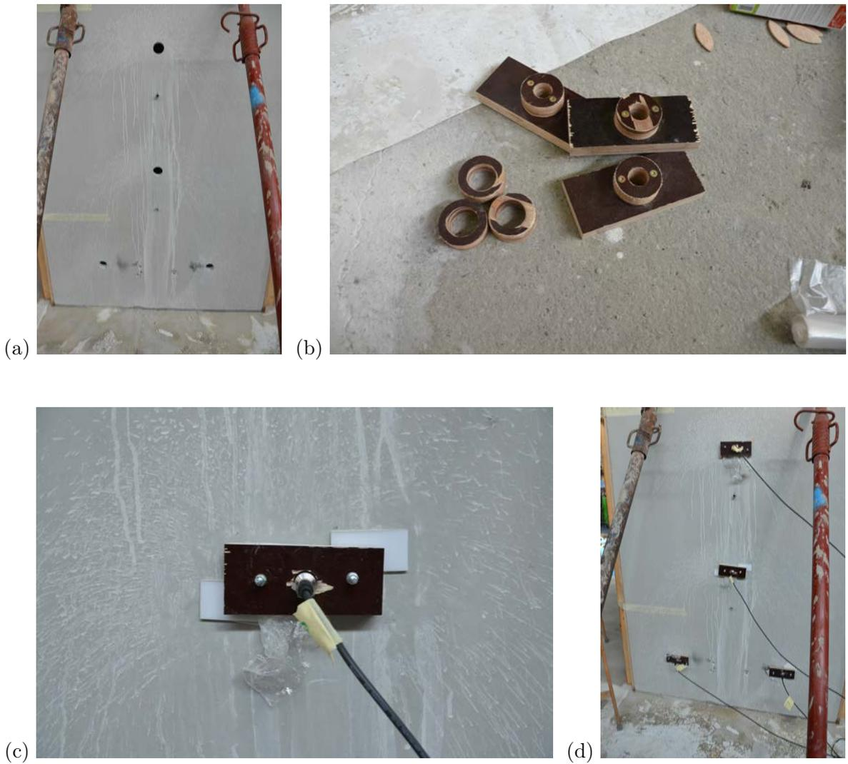
Abbildung 5.2.: Ablauf des Einbaus der Drucktransmitter
