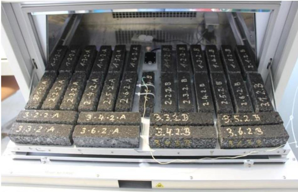
Abb. 19: Probenträger des BSS mit prismatischen Probekörper [9]
