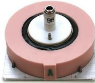
Abb. 12: Probeneinbau beim Asphalt Binder Cracking Device [28]
