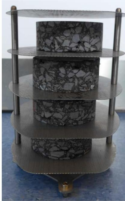
Abb. 20: Probengestell des PAV-A mit prismatischen Probenkörpern [9]
