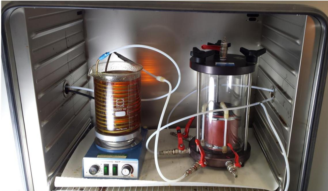
Abb. 24: Der Versuchsaufbau im Wärmeschrank (links: Anwärmspirale, rechts: Druckzelle)
