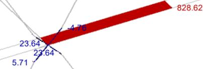
Stäbe Max V<sub>y</sub>: 828.62, Min V<sub>y</sub>: -4.76 [kN]
