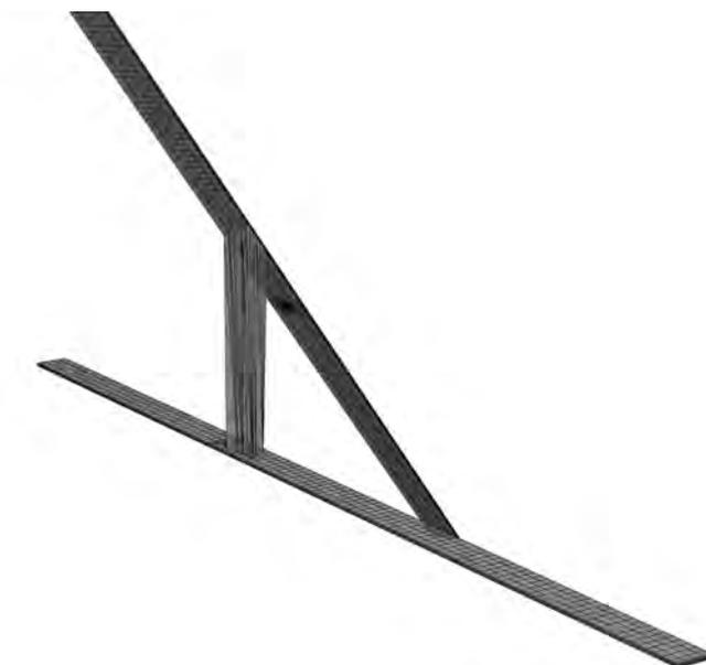
**Abbildung 3.7:** Ergebnis des Versuchs zwei weit entfernte Stäbe mit dem Befehl “tie” zu verbinden
