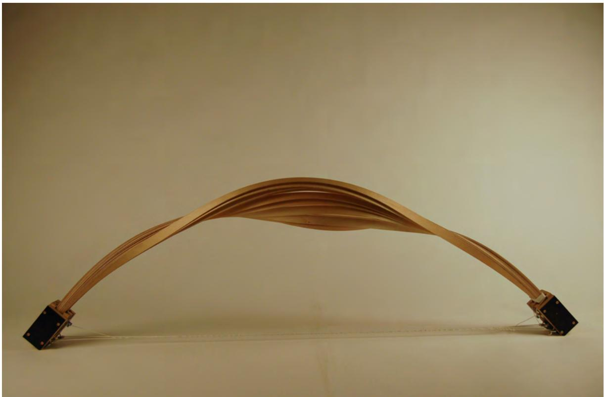
**Abbildung 2.3:** Modell mit Einfassungen der Lamellenbündel und Zugseil
