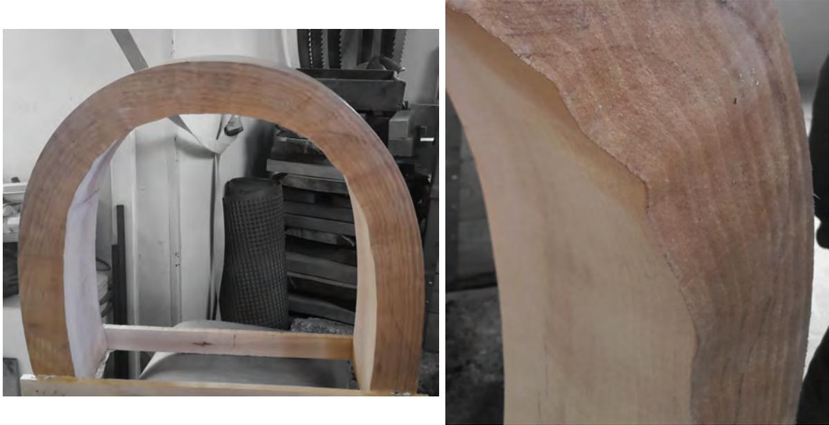
**Abbildung 1.11:** Ausbeulen der Querschnittsränder, Besichtigung Holzbiegewerk Winkler
