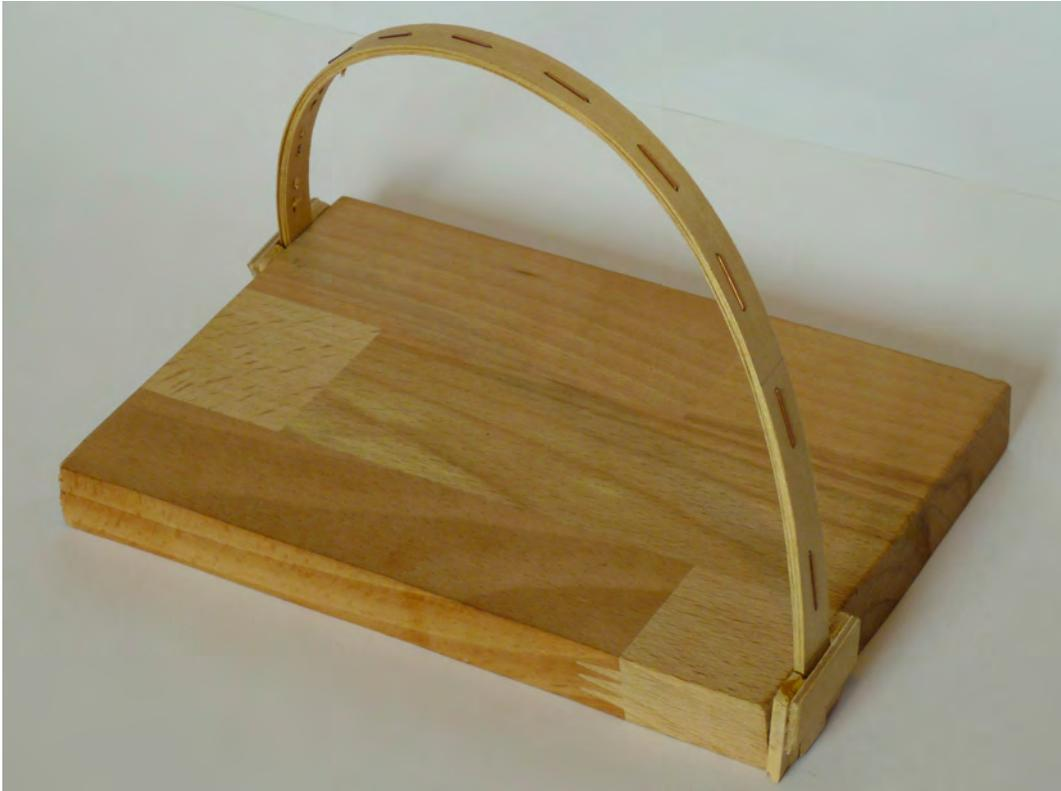
**Abbildung 2.9:** Versuchsaufbau mit mehreren verbundenen Lamellen
