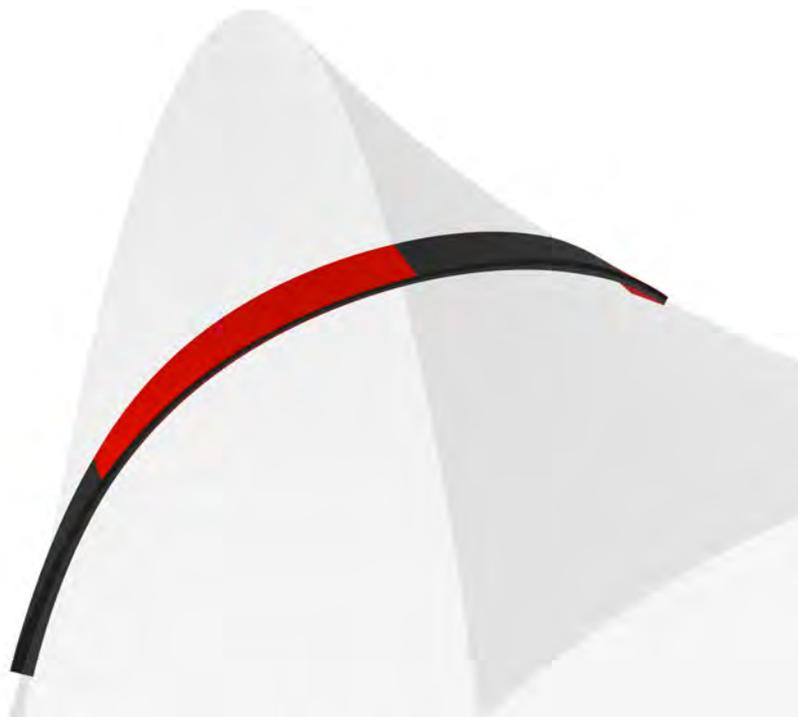
**Abbildung 2.23:** Eine festgelegte Querschnittshöhe (schwarz) wird mit der maximal möglichen Querschnittshöhe zufolge Biegung und Torsion (rot) verglichen (überhöhte Darstellung)
