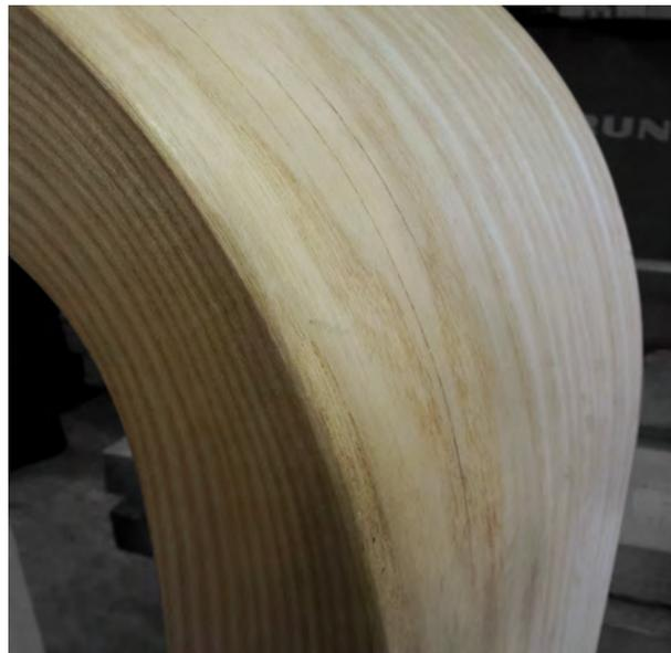
**Abbildung 1.12:** Längsrisse, ausgelöst durch Querzug, Besichtigung Holzbiegewerk Winkler
