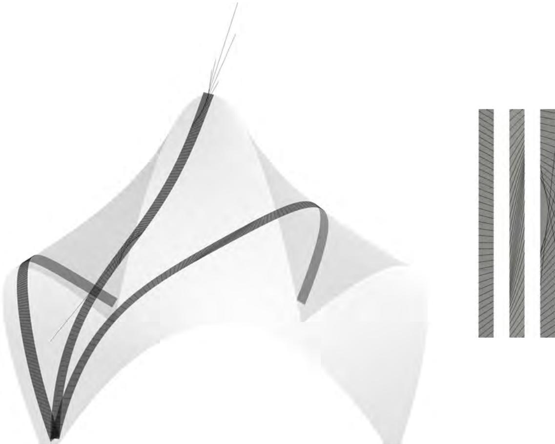
Abbildung 2.20: Links: Flächenstreifen mit den Erzeugenden  $t^*$  auf der Freiformfläche; Rechts: Ausschnitt von Abbildung 2.19 mit einer Problemstelle (rechter Streifen)
