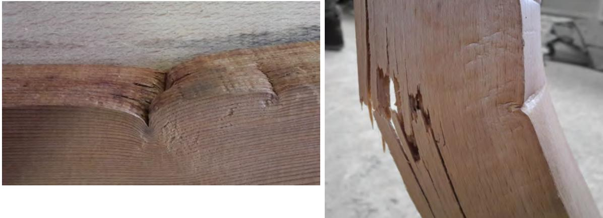
**Abbildung 1.10:** Biegedefekte und Versagen des Querschnittes durch kleine Biegeradien, Besichtigung Holzbiegewerk Winkler
