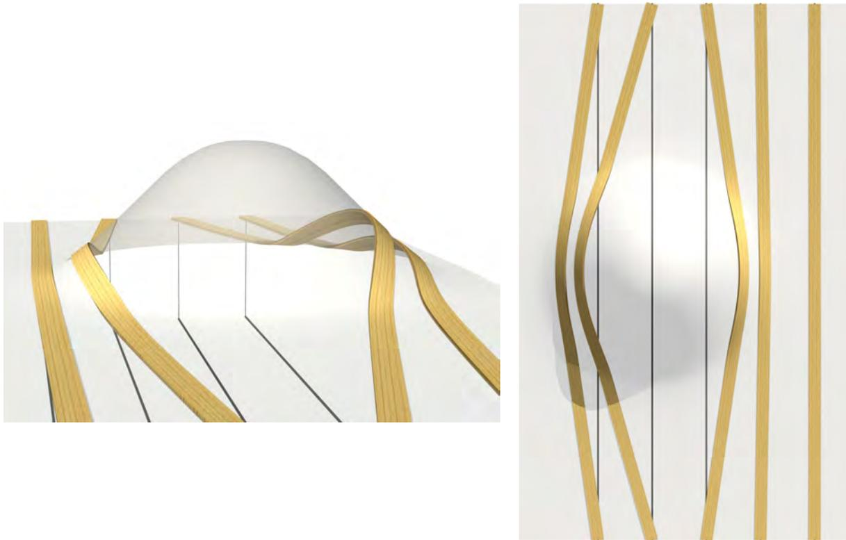
**Abbildung 2.16:** Verlauf geodätischer Linien in einem Bereich mit stark unterschiedlichen Krümmungen
