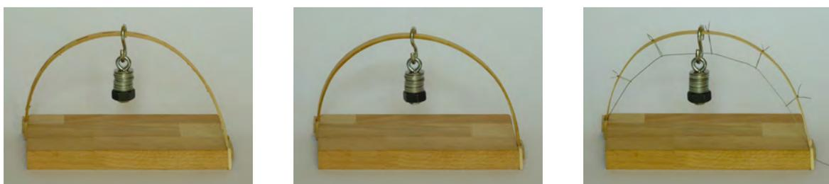
**Abbildung 2.14:** Rechts: fünf punktförmig verbundene Lamellen, Mitte: fünf verleimte Lamellen, Links: eine einzelne unterspannte Lamelle
