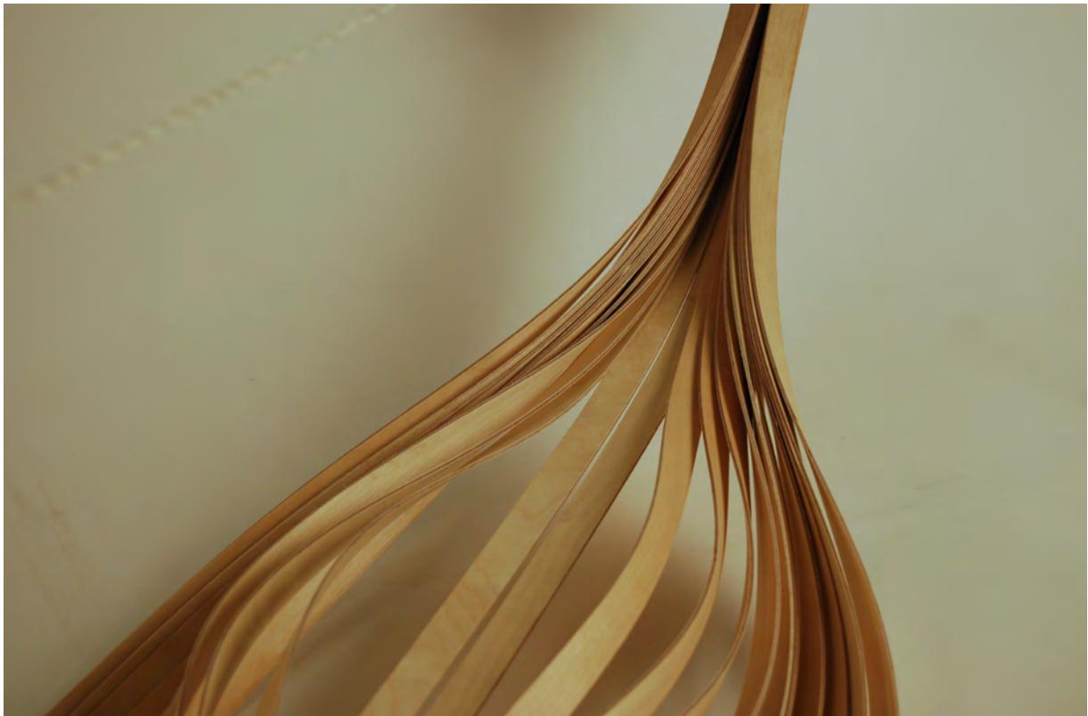
**Abbildung 2.5:** oben: geringfügige Imperfektionen in der Erzeugung führen zu ungleichmäßigem Knickverhalten, unten: Lamellen laufen in den Auflagern zusammen (Ansicht von unten)
